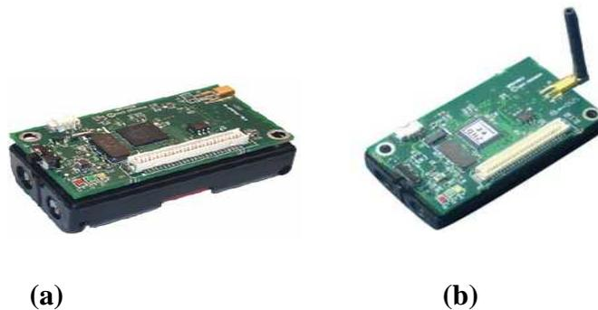
Figura 2.2 - MICA2 (a) e MICAz (b) da Crossbow. Fonte: Crossbow Technology Inc. (2008).
