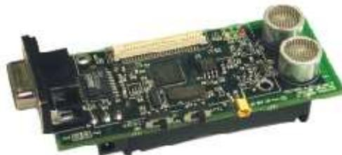
Figura 2.3 - Cricket da Crossbow. Fonte: Crossbow Technology Inc. (2008).
