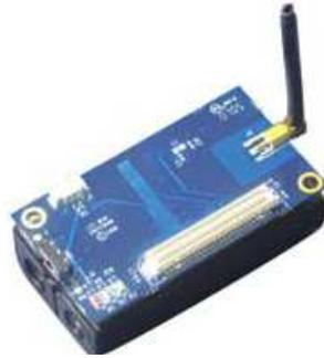
Figura 2.4 - IRIS da Crossbow. Fonte: Crossbow Technology Inc. (2008).
