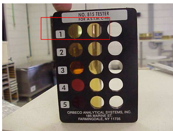
FIGURA 6. COMPARAÇÃO DA AMOSTRA DE AREIA COM O PADRÃO DA ASTM C-40 - ENSAIO ADAPTADO À NBR NM 49
