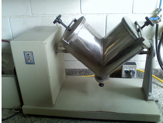
FIGURA 7. MISTURADOR EM “Y” UTILIZADO PARA MISTURA DAS COMPOSIÇÕES
