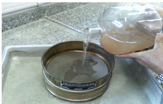
FIGURA 5. ÁGUA DE LAVAGEM CONTENDO SÓLIDOS EM SUSPENSÃO SENDO VERTIDA NA PENEIRA 75 \mu\text{m} , CONFORME ENSAIO DA NBR NM 46
