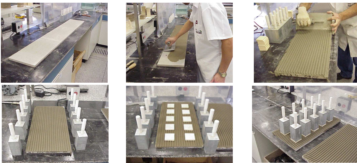
FIGURA 8. EXECUÇÃO DO ENSAIO DE DETERMINAÇÃO DO TEMPO EM ABERTO E DETERMINAÇÃO DA RESISTÊNCIA DE ADERÊNCIA À TRAÇÃO
