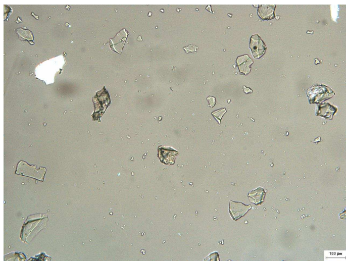
FIGURA 13. ASPECTOS DA FRAÇÃO 100 µm DA ESCÓRIA, SOB MICROSCÓPIO DE LUZ TRANSMITIDA
