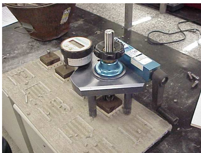
FIGURA 9. DETERMINAÇÃO DA RESISTÊNCIA DE ADERÊNCIA À TRAÇÃO - APARELHO PROCEQ DYNA Z6
