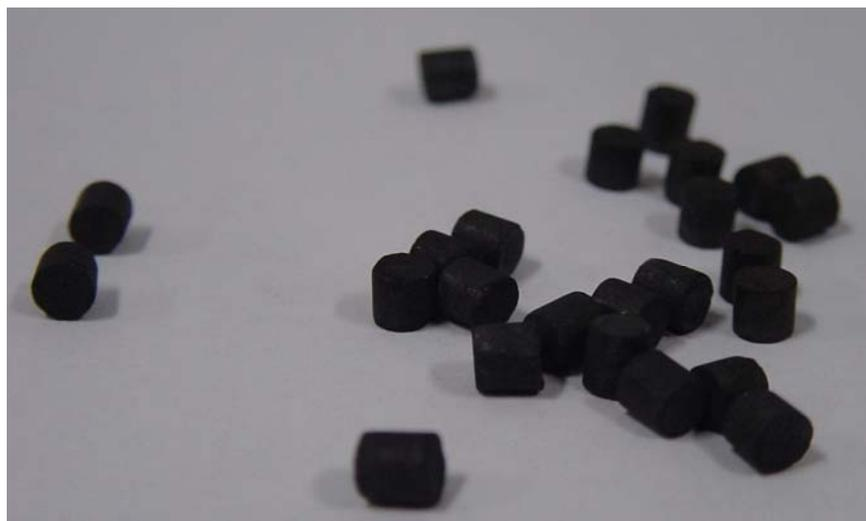
Figura 3.3. Foto do catalisador comercial CRG-F fresco
