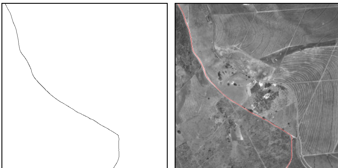
Figura 99 - Imagem resultante da Limiarização por comprimento: (a) Imagem resultante; (b) Imagem resultante sobreposta à imagem original.
