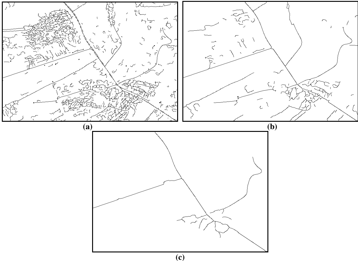
Figura 77 - Resultado da Extração: (a) Resultado da extração para o sigma igual a 1,0 (b) Resultado da extração para o sigma mínimo permitido ( \sigma = 2,0 ); (c) Resultado da extração com sigma obtido pelo método automático igual a 3,0.
