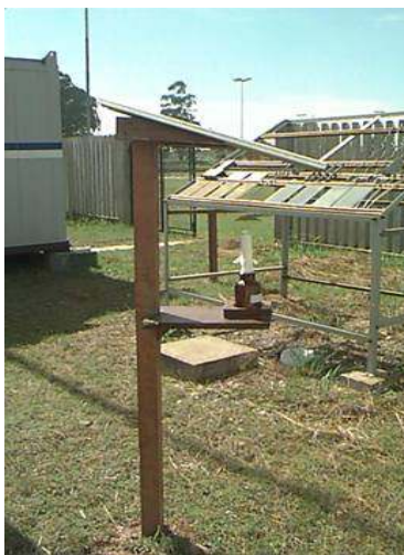
FIGURA 21. ECA1 ARAUCÁRIA-COLETOR DE CLORETOS E PAINEL DE INTEMPERISMO.
