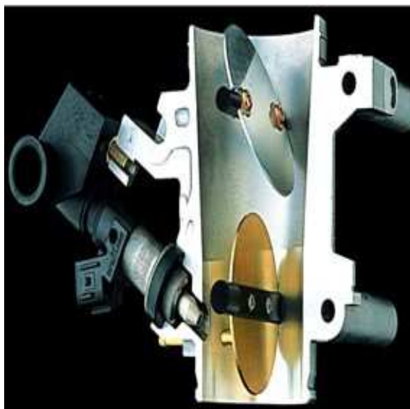
FIGURA 3 – SISTEMA DE INJEÇÃO EFI DETALHE EM CORTE. FONTE: BIRCH (2000)
