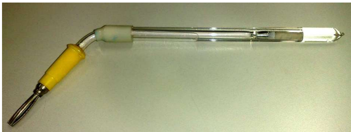
FIGURA 6 – FOTO DO ELETRODO DE CALOMELANO SATURADO USADO COMO ELETRODO DE REFERÊNCIA.
