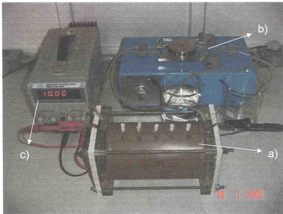
Figura 15: Arranjo experimental (a) Reator Eletrocinético, (b) Bomba Peristáltica, (c) Fonte de Potencial.
