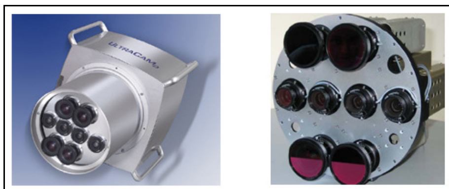
Figura 7 - Sistema aéreo digital UltraCamD – Vexcel/Microsoft (Fonte: CRAMER, 2004).
