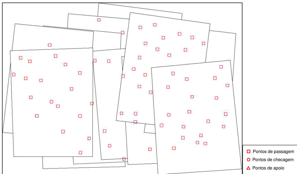
Figura 53 - Pontos de passagem ( tie points ) entre as imagens.
