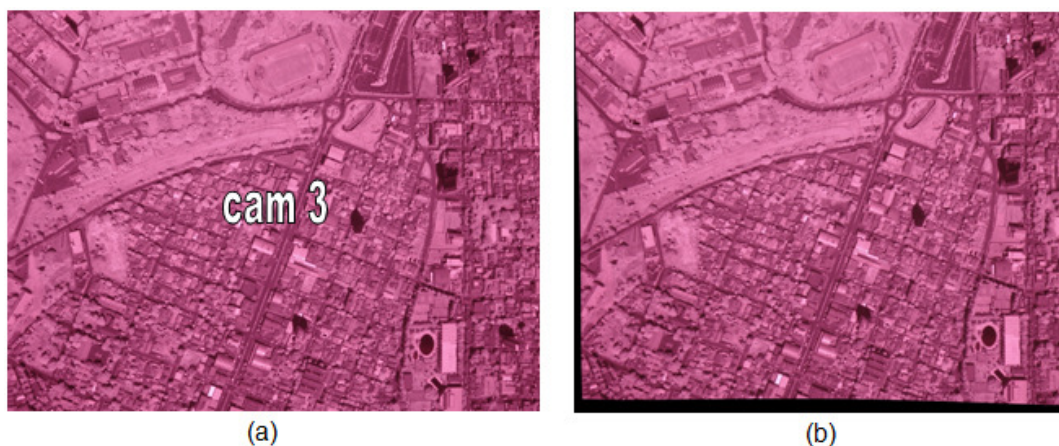
Figura 58 - Retificação da imagem IR: (a) Imagem IR original, (b) Imagem IR retificada.
