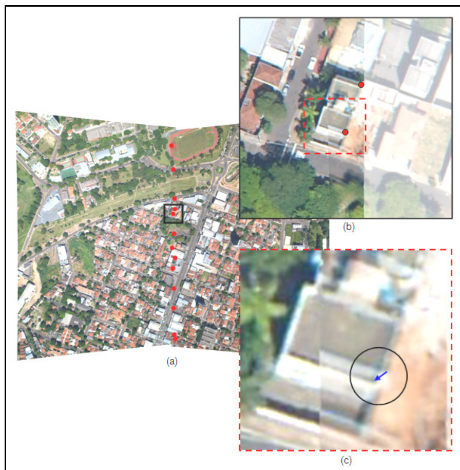
Figura 46 - Detalhes dos pontos medidos para estimativa da translação entre as imagens: (a) Pontos medidos, (b) Detalhe de um dos pontos, (c) Vetor deslocamento do ponto, entre as imagens.
