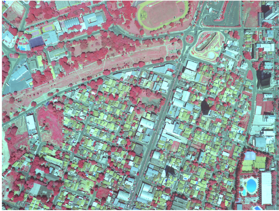
Figura 63 - Composição colorida com o canal do IR (IR, R, G).
