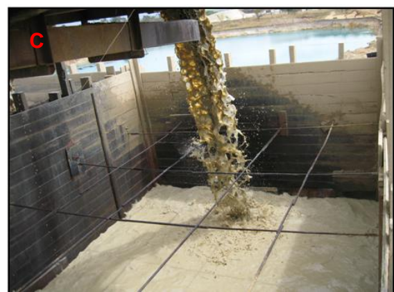
Figura 10: Etapas da extração de areia em ambiente de cava no areal Tropicaliente - (A) Localização do Areal Tropicaliente, na bacia do Guandu; (B) logo após a areia misturada com a água é bombeada para caixas suspensas; onde (C) a seleção granulométrica é feita pela desagregação das partículas através de lavagem (Fotos: T. M. Silva, 2008).
