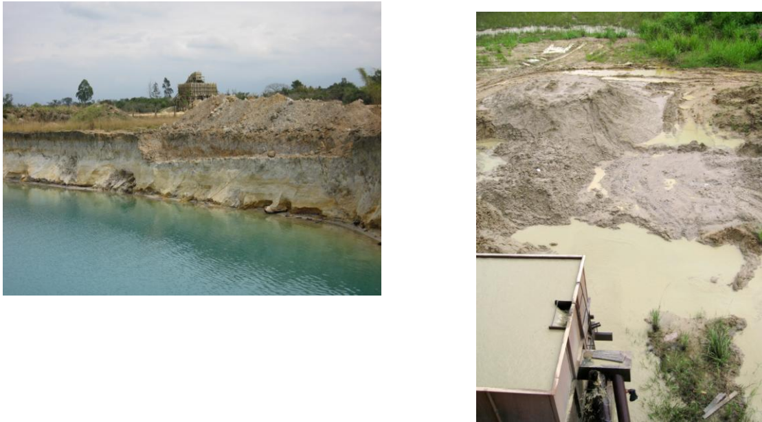
Figura 7: Cenário da mineração de areia: (A) progressão vertical da cava, com aprofundamento da escavação e exposição do lençol freático; (B) seleção granulométrica através de lavagem, com deposição dos sedimentos finos na lagoa de rejeitos - Areal Tropicaliente, em Itaguaí (Fotos: S. L. S. Silva, 2009).
