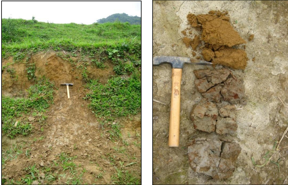
Figura 17: A – Localização do Perfil estratigráfico realizado em corte adjacente ao canal; B - Camadas identificadas em campo e coletadas para posterior análise granulométrica em laboratório (Fotos: S.L.S. SILVA, 2009).
