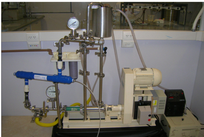
Figura 1 Fotografia da unidade piloto de microfiltração utilizada nos experimentos.
