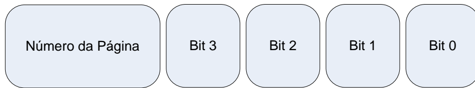
Figura 4.3: Formato do comando de configuração
