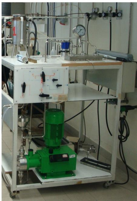
**Figura 7 - Reator de membrana utilizado para fracionamento da mistura de mono-, di- e oligossacarídeos.**
