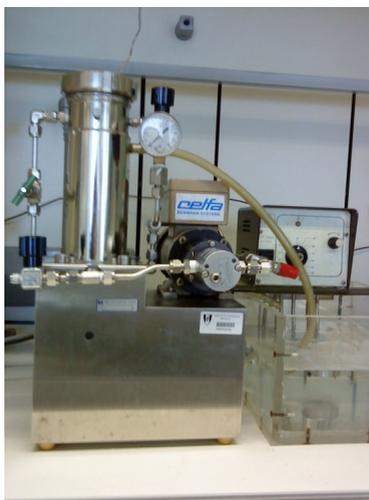
**Figura 8 – Unidade de filtração Celfa P-28 utilizada para a síntese e fracionamento simultâneo de oligossacarídeos.**
