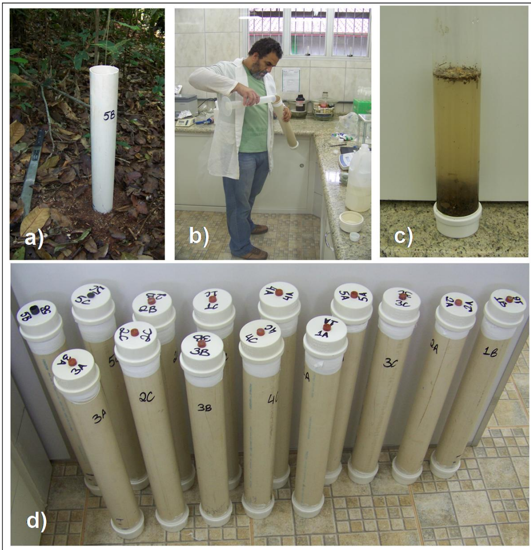
Figura 24. Preparo do experimento de inundação. a) Perfil de solo. b) Enchimento dos tubos com água do igarapé. c) Tubo inundado com 1,5 L de água do igarapé. d) Tubos de PVC vedados contendo os perfis do solo e água do igarapé.
