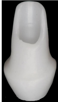
Figura 28 – Contração de 25% após sinterização.
