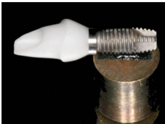
Figura 33 – Conjunto implante/intermediário após fixação, preparados para leitura em MEV.
