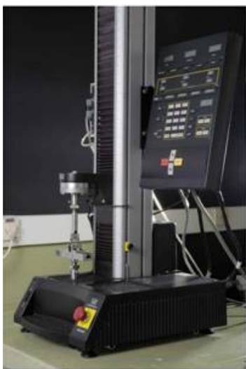
Figura 36 - Máquina de ensaios universal (Modelo 4444, Instron, EUA).
