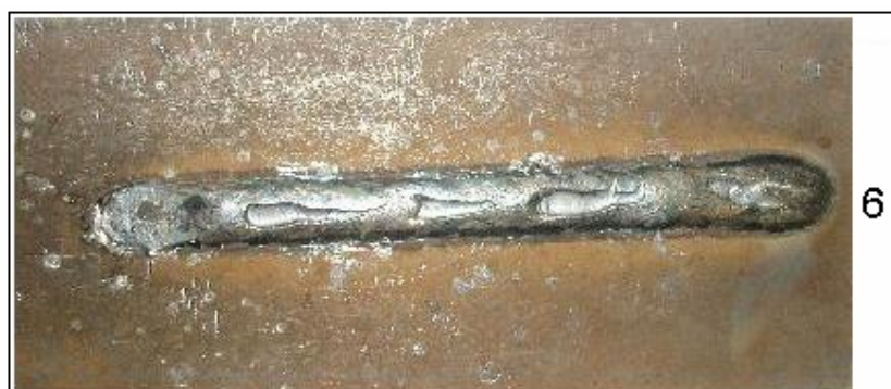
Figura 4.3 – Defeito superficial representado por uma porosidade alongada.
