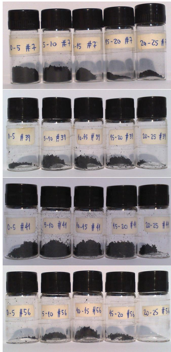
Figura 3.8: Exemplos de armazenamento do material recolhido por setores. Em determinadas deposições pode ocorrer de material não se formar em algum setor particular do tubo como pode ser visto para a amostra #56\_E.
