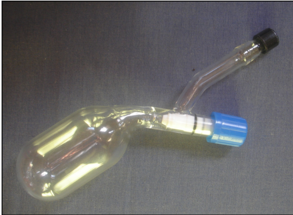
Figura 6. Ampola utilizada para coleta do gás produzido no bioretor.
