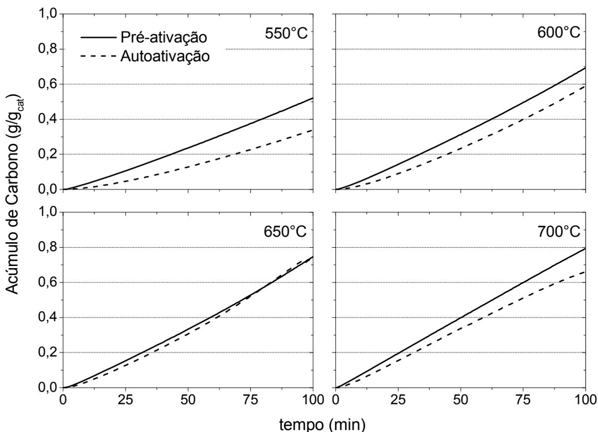
**Figura 3.17:** Efeito da forma de ativação na quantidade de carbono depositado, para o catalisador Co66Al33, em reações com pré-ativação (—) ou com autoativação (- - -)
