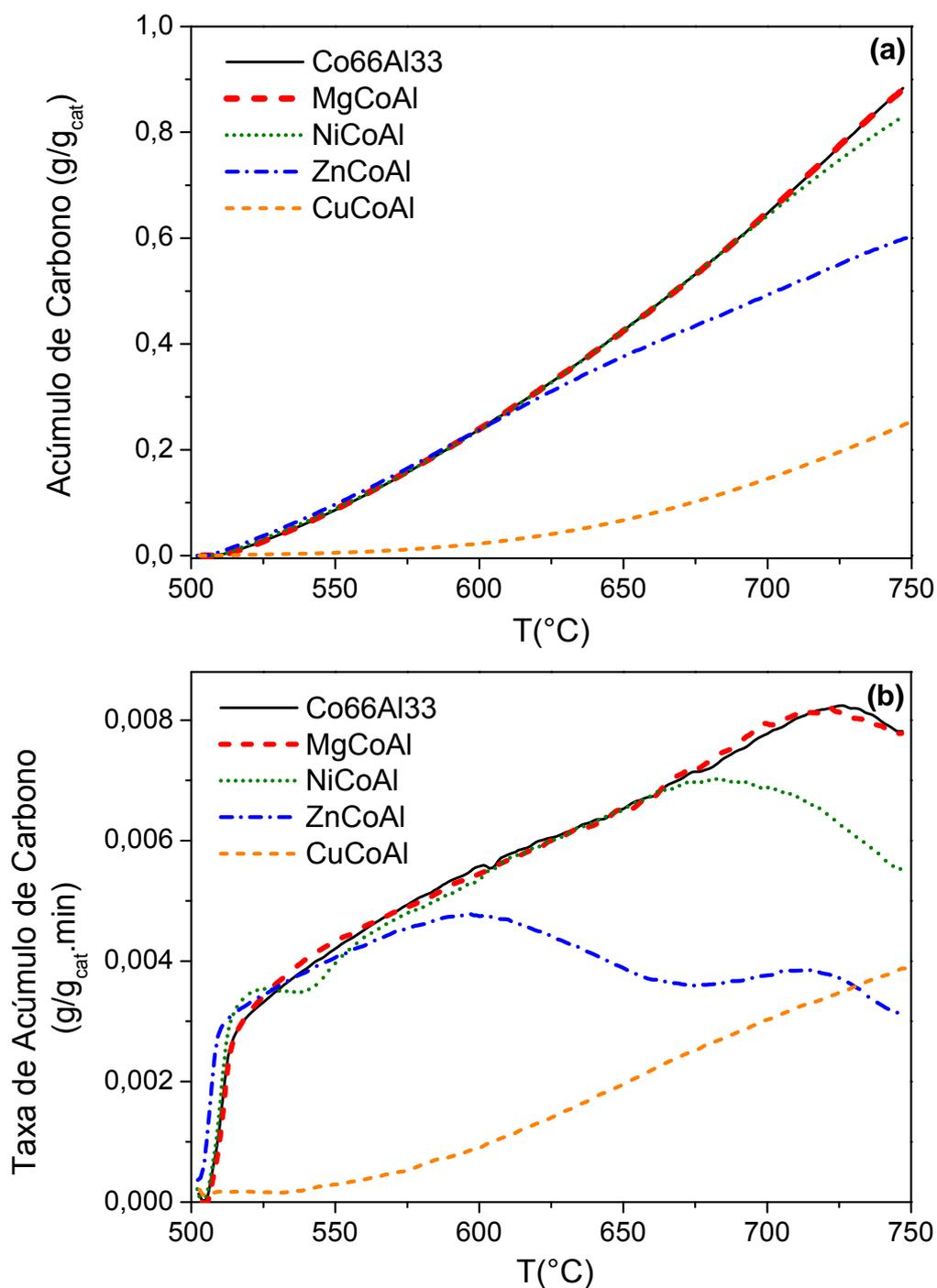
**Figura 3.13:** Desempenho de catalisadores contendo um terceiro metal em reações com elevação da temperatura (2°C/min): a) Massa de carbono acumulado; b) Taxa de acúmulo de carbono
