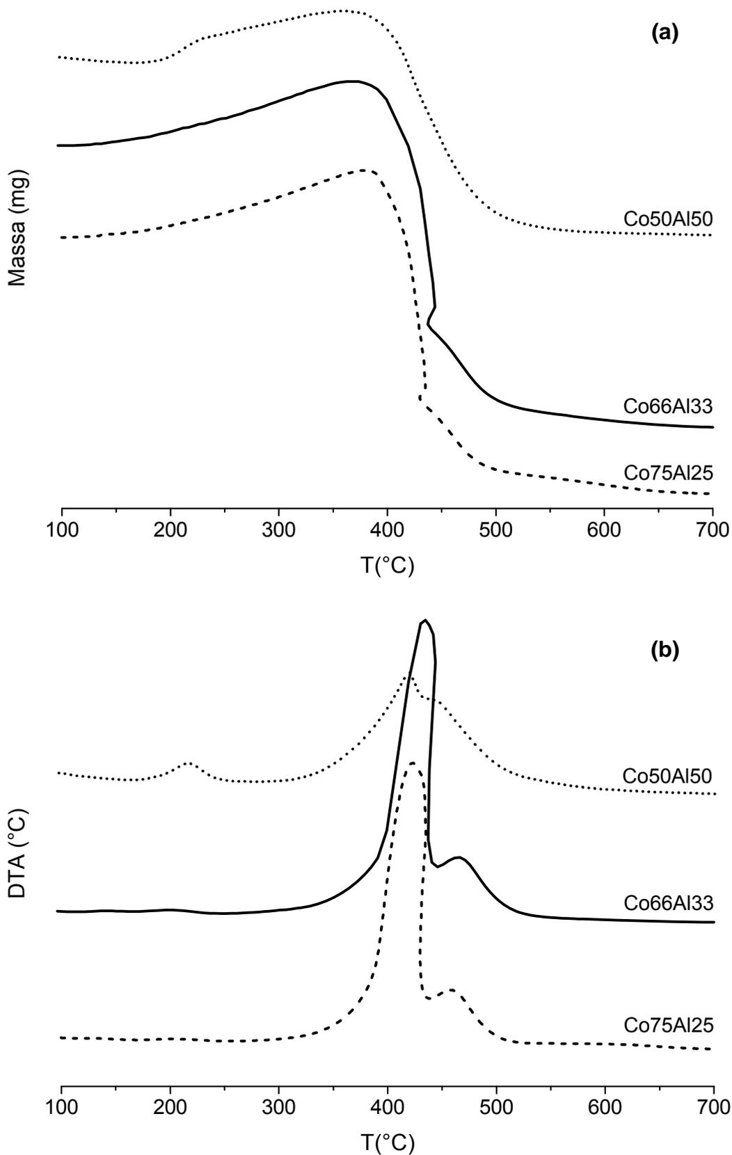
**Figura 3.22:** Análises de TPO para os catalisadores contendo somente Co e Al, usados em reações com taxa de aquecimento de 2°C/min: a) Variação da massa; b) Sinal da DTA
