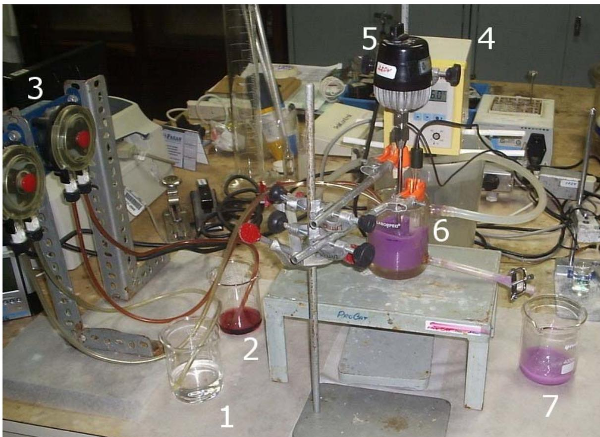
**Figura 2.2:** Aparelhagem utilizada na coprecipitação: 1) Solução alcalina; 2) Solução de nitratos dos metais; 3) Bombas peristálticas; 4) Banho termostático; 5) Impelidor mecânico; 6) CSTR encamisado; 7) Coleta do precipitado
