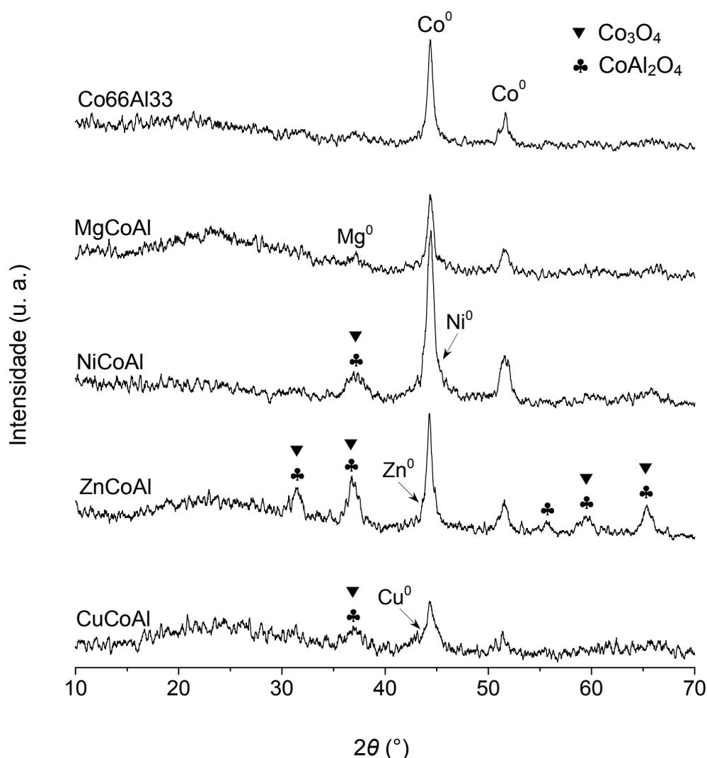
**Figura 3.12:** Análises de DRX de amostras reduzidas dos catalisadores contendo um terceiro metal
