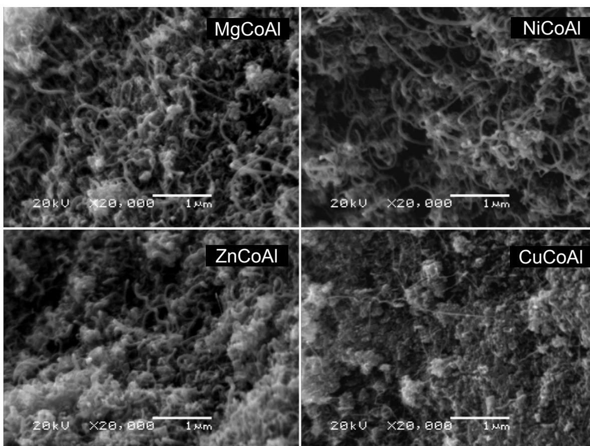
**Figura 3.14:** Imagens de MEV para os catalisadores contendo um terceiro metal, usados em reações com taxa de aquecimento de 2°C/min
