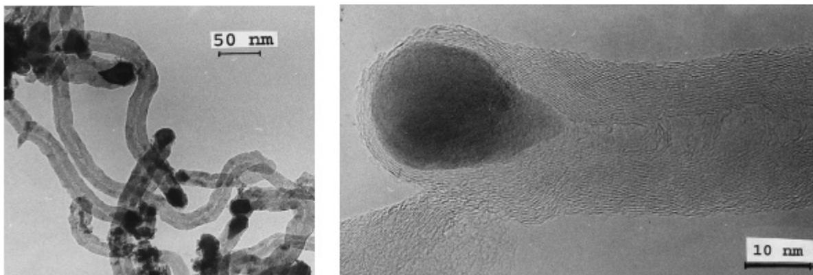
**Figura 1.4:** Imagens de CNTs obtidas por microscopia eletrônica de transmissão (AVDEEVA et al., 1999)
