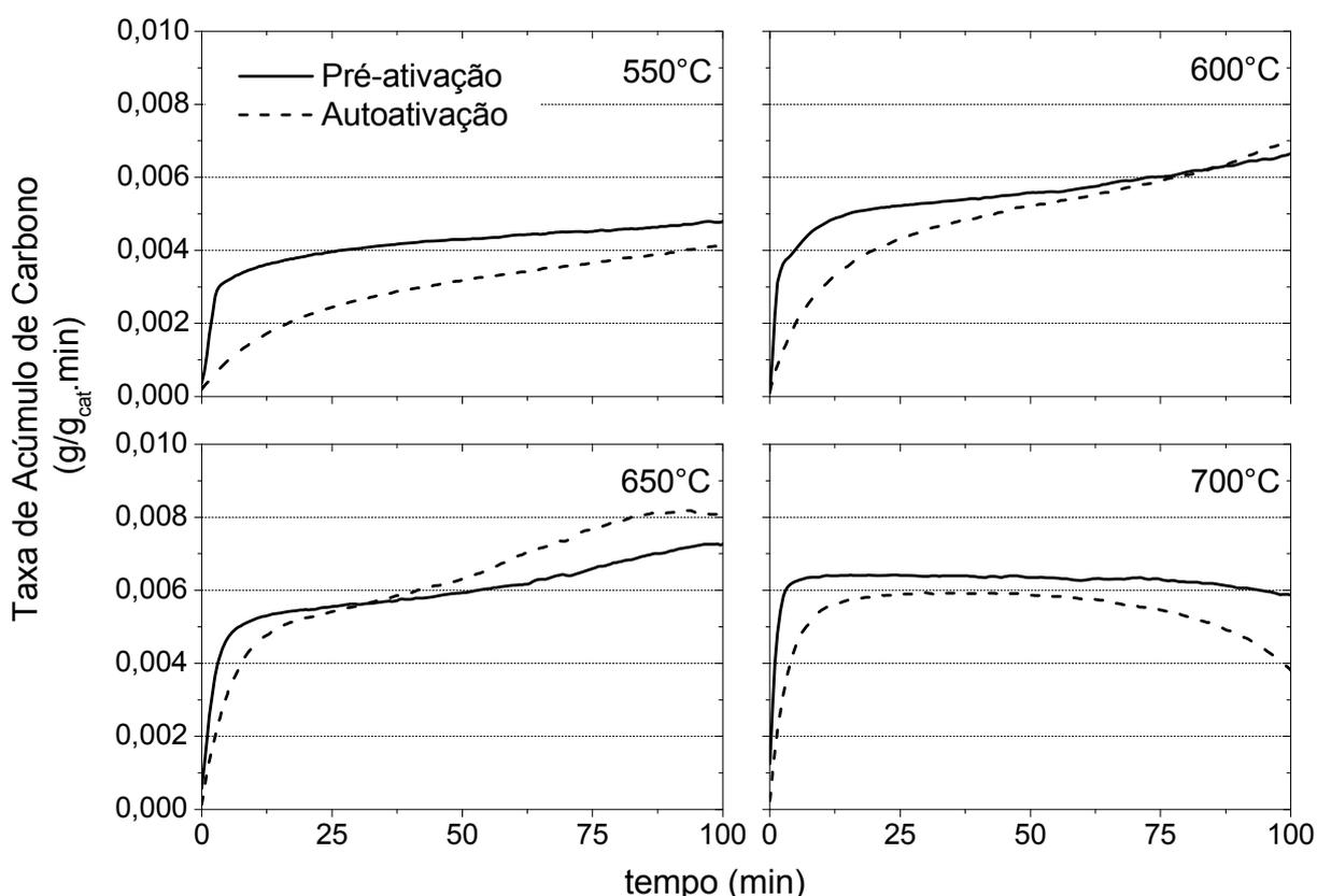
**Figura 3.18:** Efeito da forma de ativação na taxa de acúmulo de carbono, para o catalisador Co<sub>66</sub>Al<sub>33</sub>, em reações com pré-ativação (—) ou com autoativação (- - -)
