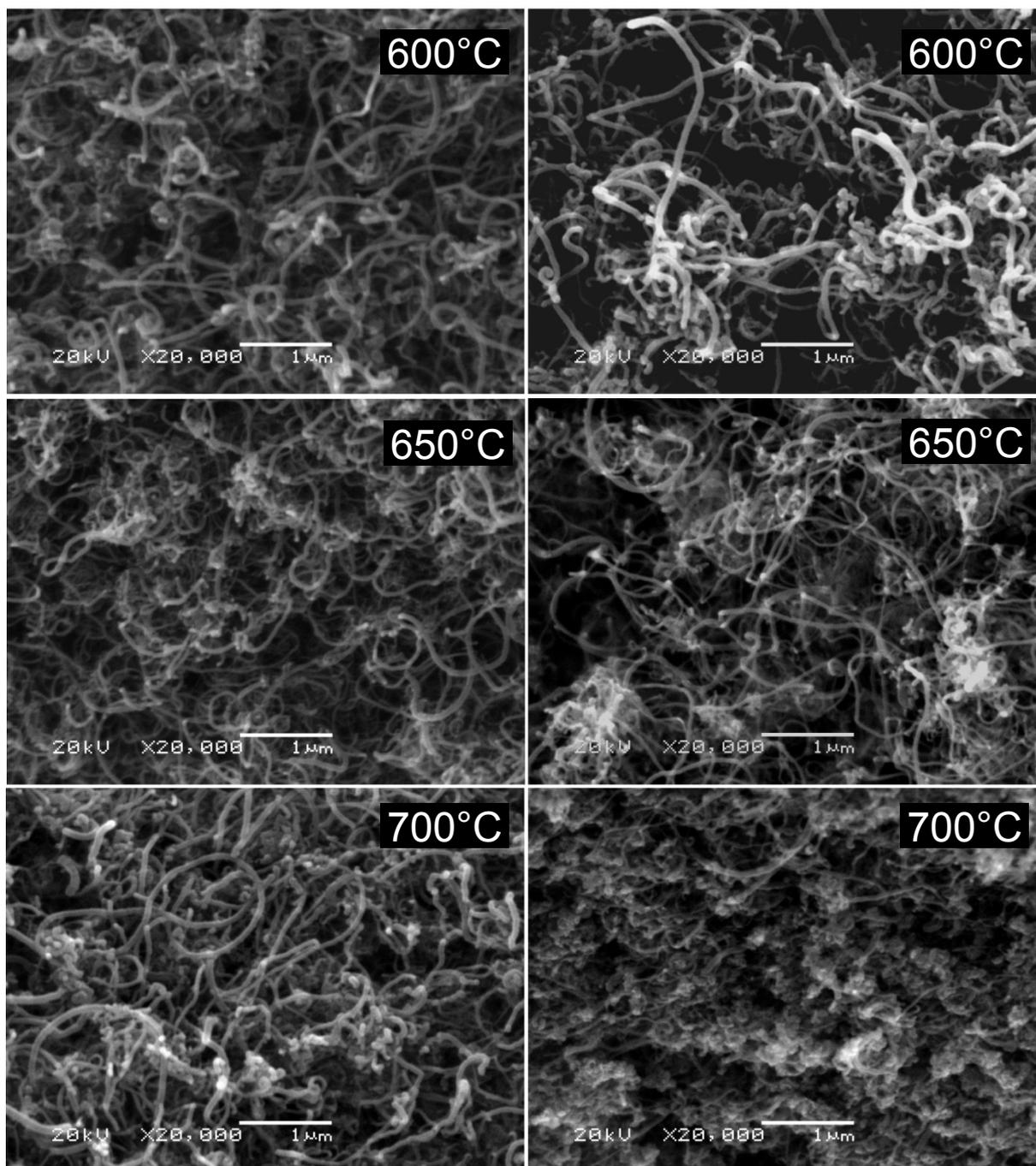
**Figura 3.21:** Imagens de MEV para amostras do catalisador Co<sub>66</sub>Al<sub>33</sub>, usadas em reações isotérmicas
