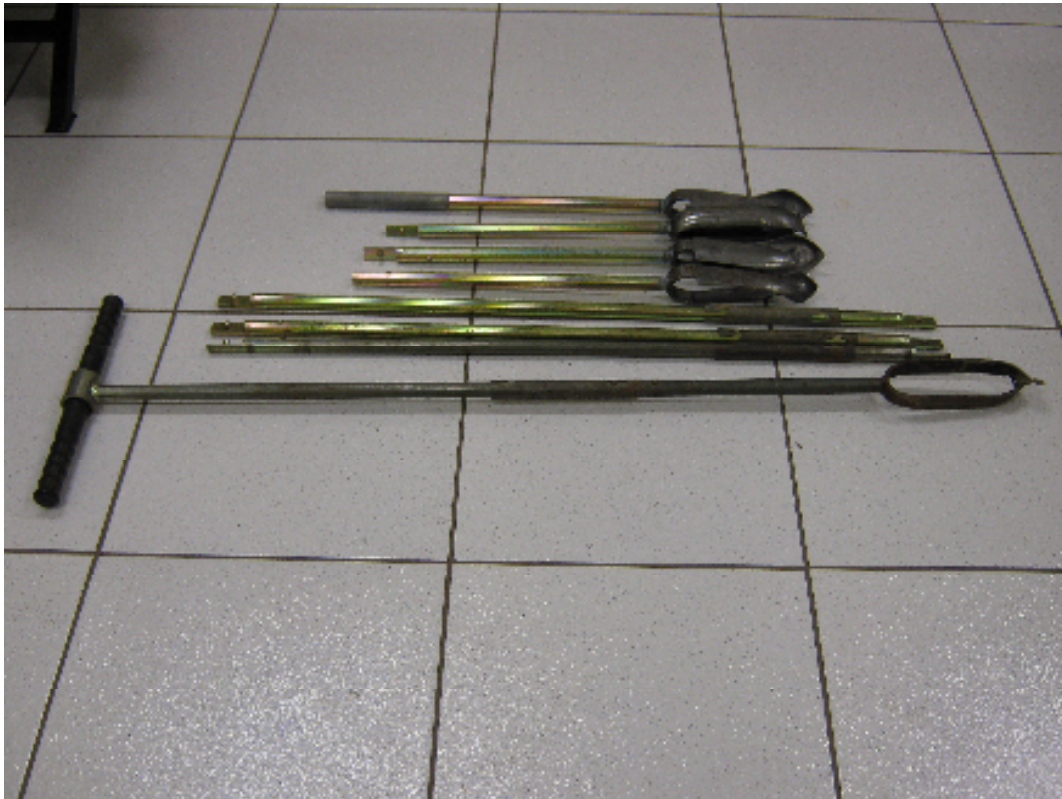
Foto 2: Trado holandês utilizado para sondagem de formações superficiais. Foto: Marga Eliz Pontelli, novembro/2009
