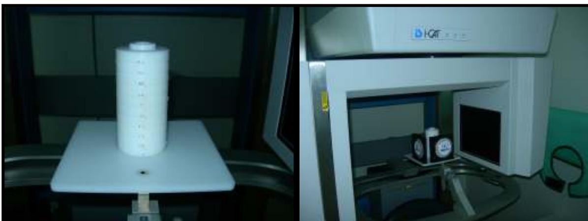
Figura 13 - Posicionamento do *phantom* no i-CAT™.
