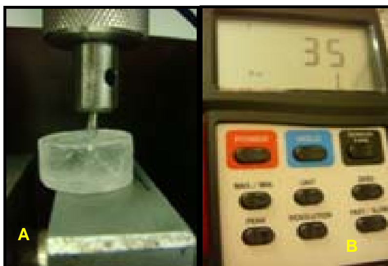
Figura 3 - A) Implante de corpo único posicionado para teste em EMIC; B) Torquímetro digital.
