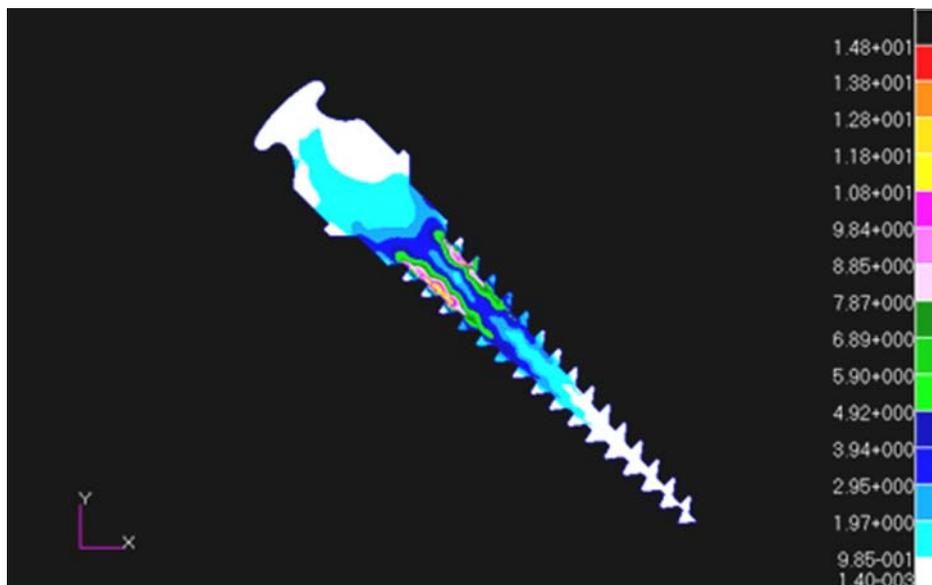
Figura 16 - Tensão de von Mises no mini-implante a 45°
