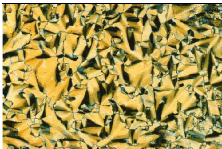
Textura mosaico paramórfica da mesofase esmética I no selenoéster 1b , resfriamento (10x), 82°C.
