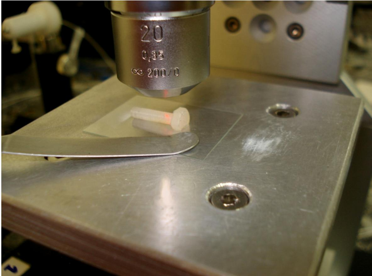
Figura 12: Detalhe do braço de amostra exibindo a amostra em prova, colada sobre uma lâmina de vidro. O feixe laser vermelho é utilizado para identificar o ponto amostrado.
