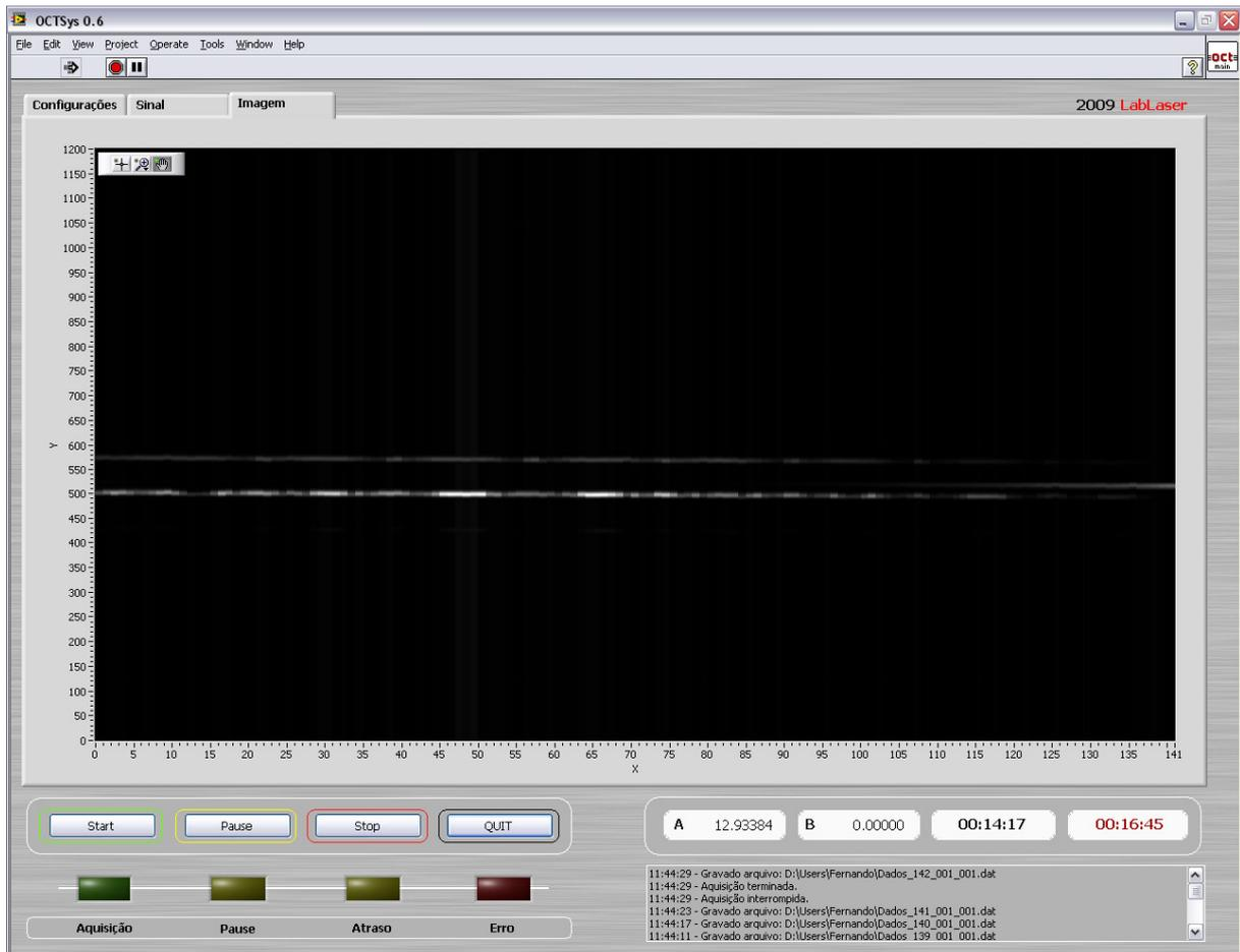
Figura 21: Aba 'Imagem', mostrando em duas dimensões a imagem obtida através da união dos tomogramas vizinhos.
