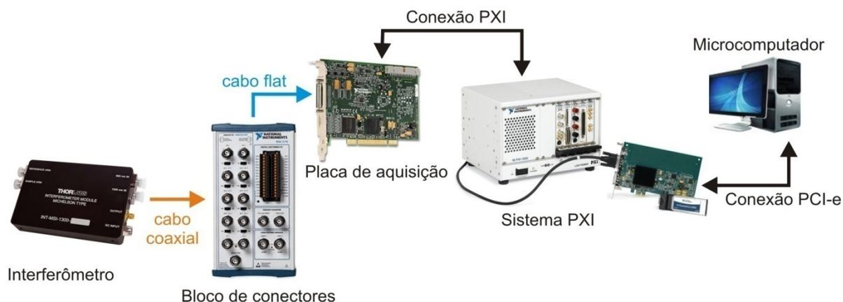
Figura 16: Blocos do sistema de aquisição.
