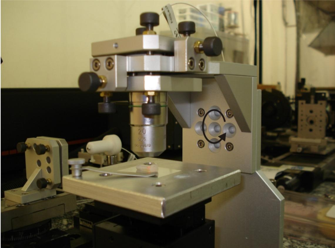
Figura 13: A mudança da montagem do braço de amostra possibilita alterar a direção do feixe: vertical ou horizontal. O ajuste é feito através dos parafusos próximos à seta desenhada.
