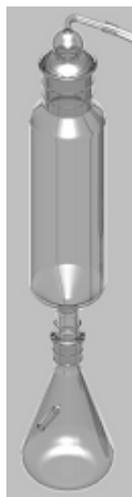
FIGURA 12 - UMA DAS COLUNAS DO SISTEMA DE BIOFILTRAÇÃO
