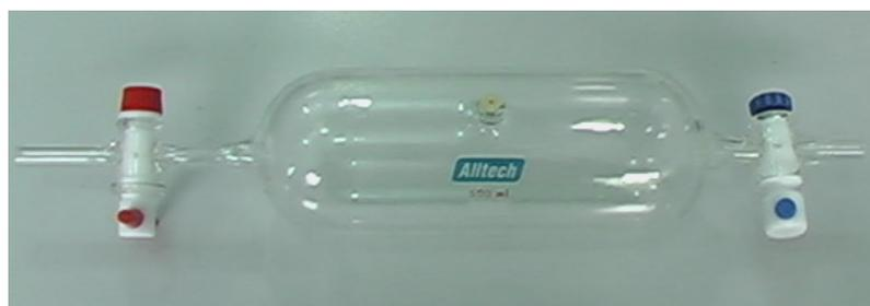
FIGURA 17 - FRASCO AMOSTRADOR DE GASES, UTILIZADO NA DETERMINAÇÃO DAS CURVAS DE CALIBRAÇÃO
