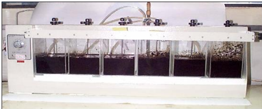
Figura 11 – Equipamento Jar Test utilizado na extração das substâncias húmicas das amostras coletadas na margem direita do Córrego da Paixão no município de Dobrada-SP.
