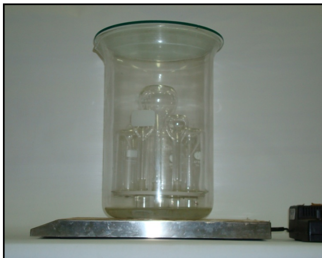
Figura 5 – Sistema de limpeza de vidraria.
