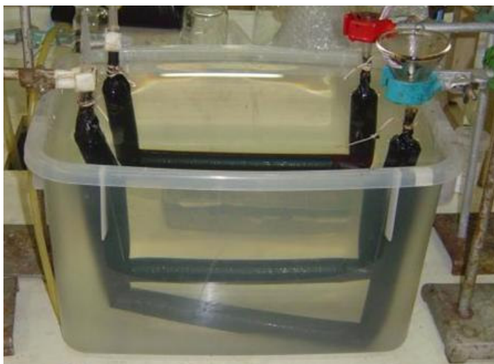
Figura II.6. Purificação das substâncias húmicas extraídas por fluxo contínuo de amostras de turfas.
