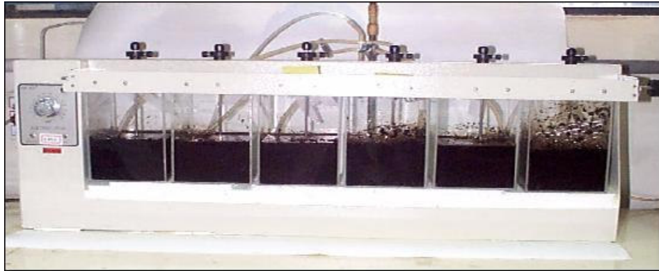
Figura II.5. Equipamento de extração das substâncias húmicas de amostras de turfas por batelada.
