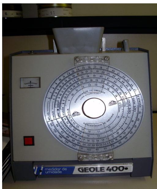
Figura 3. Medidor de Umidade marca Geole 400.
