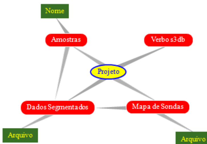
Figura 5.3: Estrutura de dados de repositório S3DB compatível com CNViewer. Mapa adaptado com base na representação gerada pela interface do S3DB. Os elementos do banco são vinculados por verbos, este relacionamento está representado em cinza, sendo que a extremidade espessa da linha indica o sujeito da relação e a outra ponta, o objeto. Um Projeto possui diversas coleções (caixas vermelhas), as quais estão armazenando os dados (caixas verdes) sob forma de texto ou arquivo.
