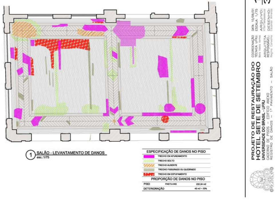
Imagem 311 – Caderno de Pisos: Levantamento dos danos nos pisos – salão – Prédio Anexo.
