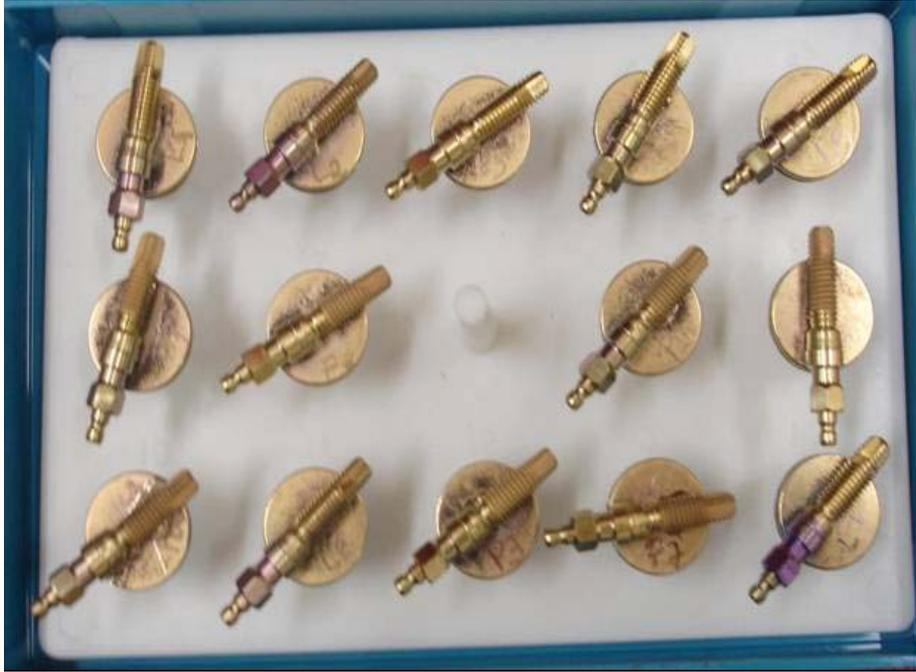
FIGURA 2 - Amostras recobertas com camada de ouro (20nm) pela técnica de Sputtering..
