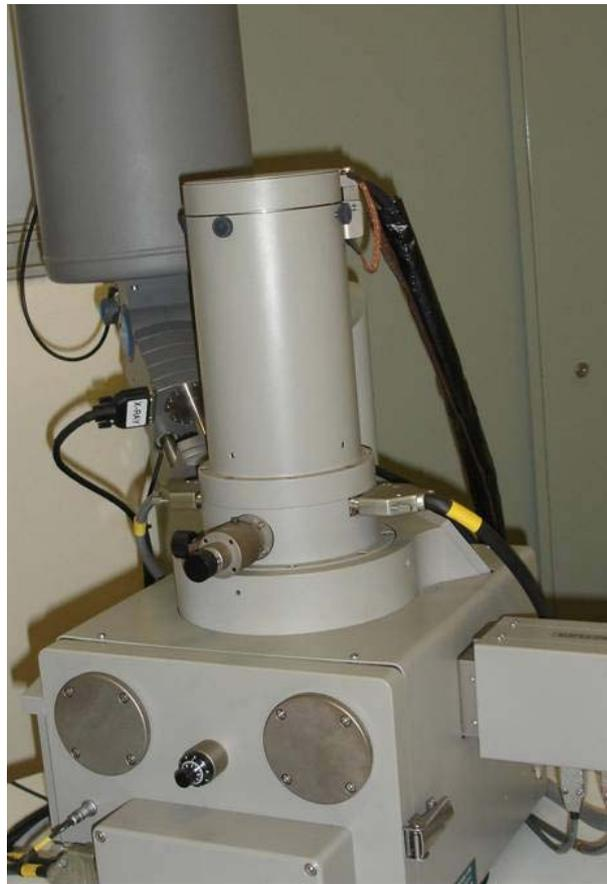
FIGURA 3 - Microscópio Eletrônico de Varredura – LEO 430.
