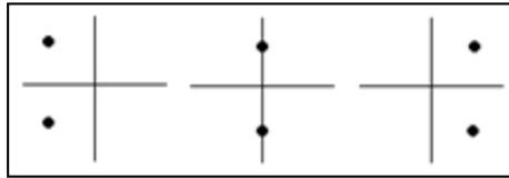
Figura 5.4: Localização dos autovalores no plano complexo em função de \mu . Adaptado: Bequette, 1998.
