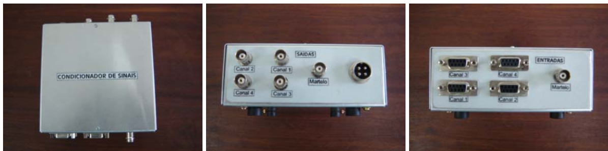
Figura 7.12: Painéis de saídas entradas do condicionador e amplificador de sinais
