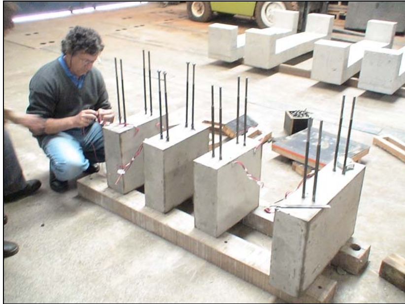
Figura 3.27 - Verificação da instrumentação interna.
