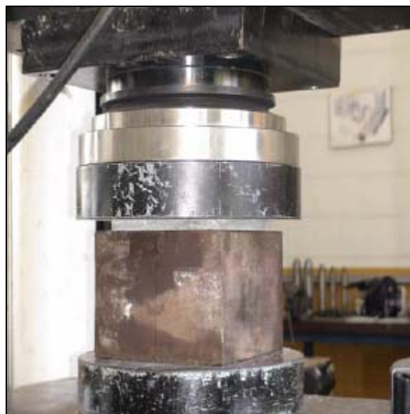
Figura 2.31 – Esquema do ensaio de carregamento monotônico (SIQUEIRA,2007).
