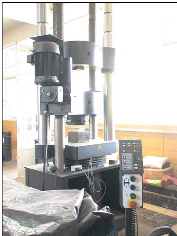
Figura 3.22 - Ensaio de rigidez de placa.
