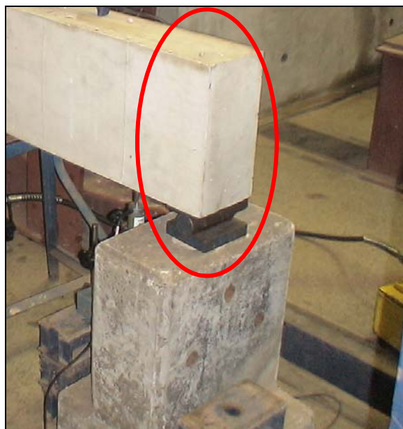
Figura 5.15 - Sistema de apoio modificado para Modelo 4.
