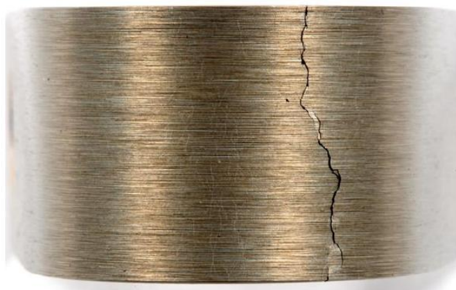
Figura 5.17: trinca de SCC com penetração total, próxima ao ápice de um espécime U-bend 304L após 712 h em licor com 25 g/L NaOH a 165 °C (Wensley, 2007).
