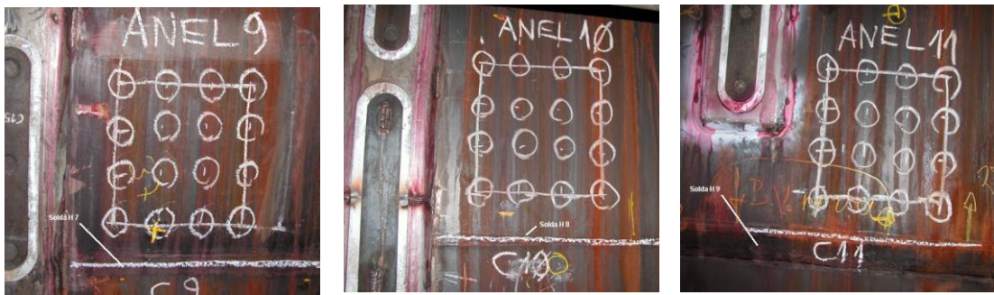
Figuras 5.7 (a), (b) e (c): regiões-testemunha para monitoramento rigoroso da evolução das espessuras, respectivamente anel 9, 10 e 11 (MKS, 2004).
