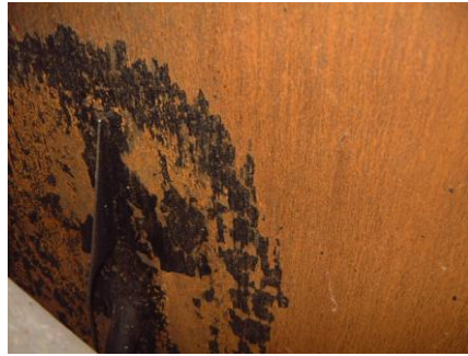
Figura 5.2: área ativa do costado com corrosão uniforme (CENIBRA, 2002).
