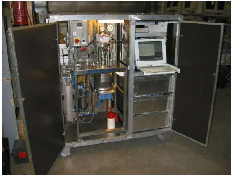
Figura 4.3: equipamento utilizado para teste Contact Electric Resistance , CER (Savcor, 2009).
