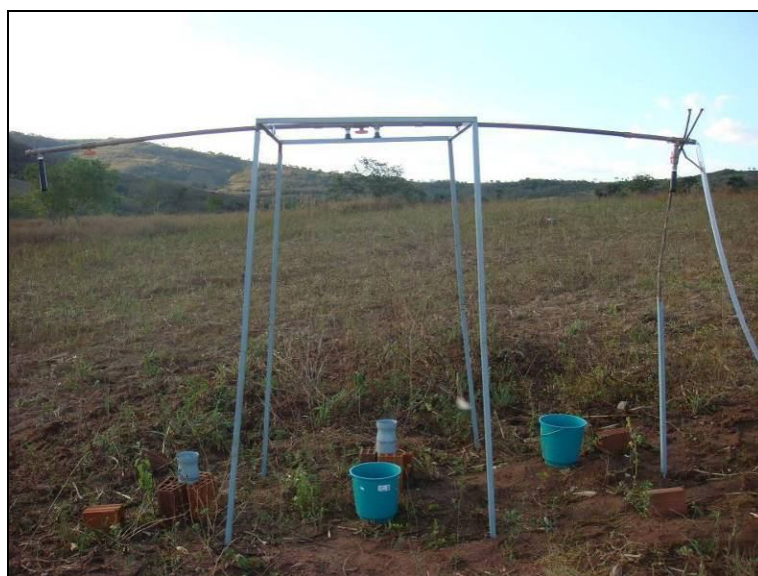
Figura 24 – Configuração utilizada durante o processo de calibração do simulador de chuva.
