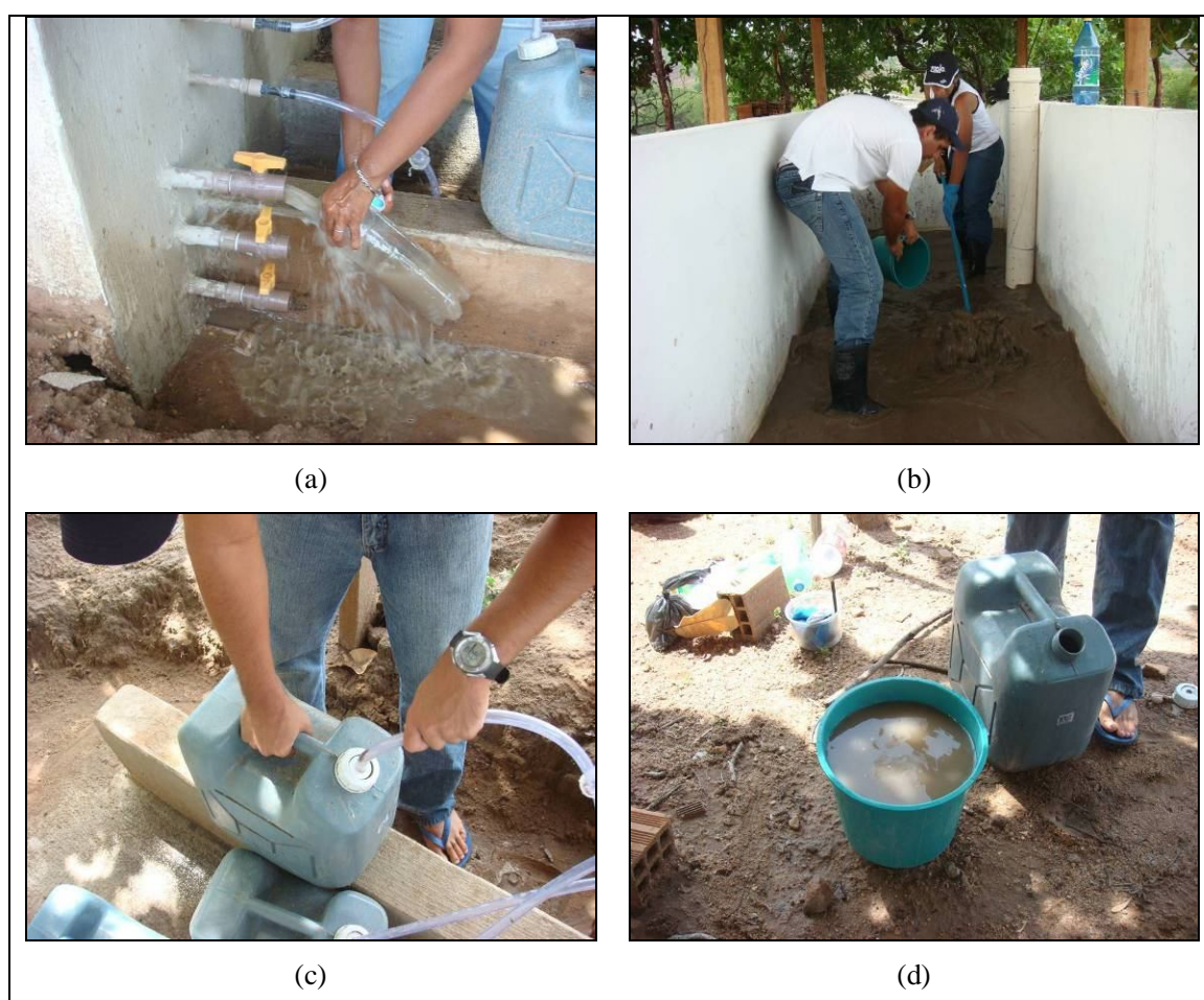
Figura 20 – Etapas do processo de amostragem na fossa de sedimentos: (a) Amostragem através de sifonagem em um tubo de amostragem manual; (b) Amostragem de fundo; (c) Recipiente conectado a um tubo de amostragem automática; e (d) Coleta de amostra através de um recipiente conectado a um tubo de amostragem automática.
