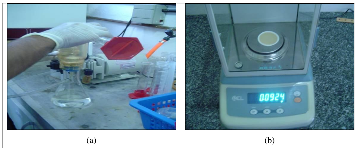
Figura 22 – Etapas da análise laboratorial: (a) Processo de filtração da amostra com o auxílio de uma bomba de vácuo; e (b) Pesagem da membrana filtrante utilizando balança de precisão.
