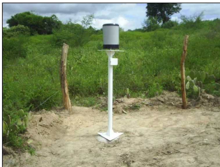
Figura 19 – Pluviógrafo CS700 (CAMPBELL SCIENTIFIC) instalado nas proximidades da microbacia.
