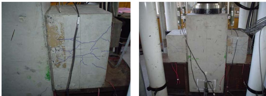
Figura 4.8: Aspecto da fissuração do modelo 03
