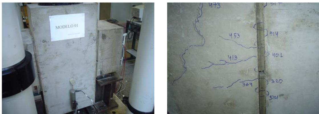
Figura 4.15: Aspecto da fissuração do modelo 01
