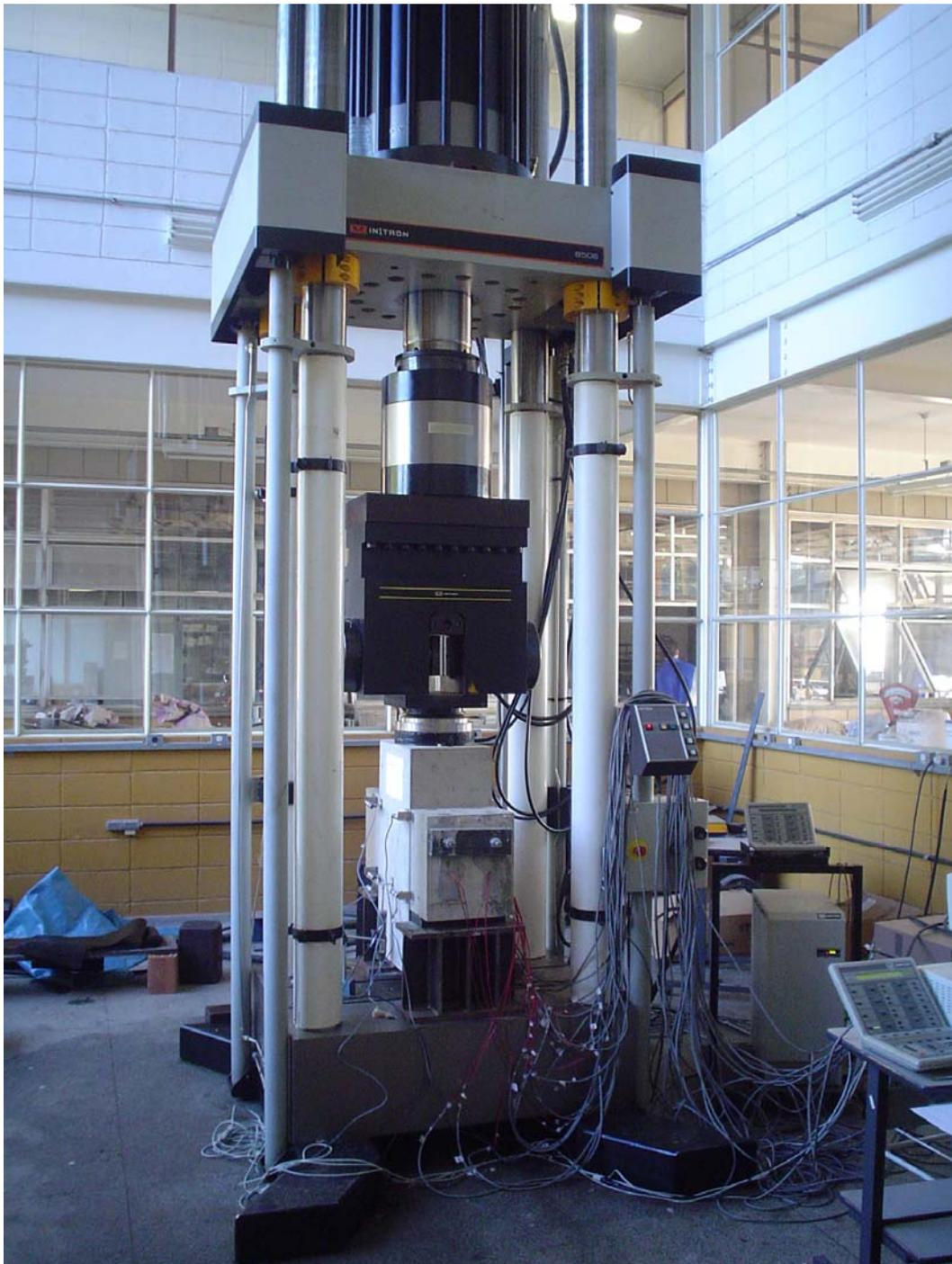
Figura 3.34: esquema de ensaio na máquina INSTRON 8506
