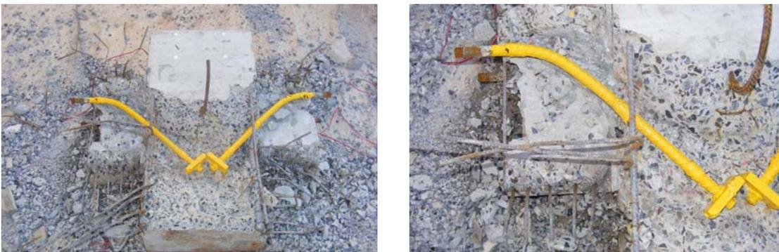
Figura 4.31: Deformada do chumbador do modelo 09
