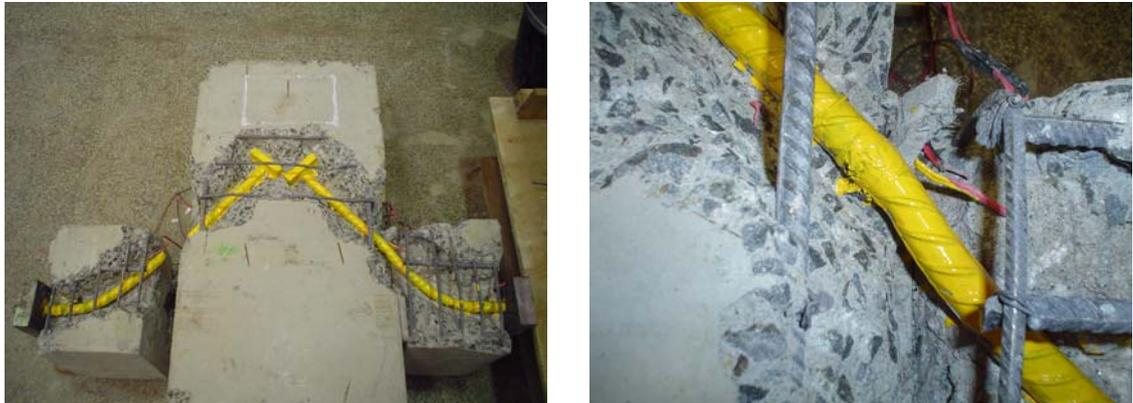
Figura 4.5: Detalhe do chumbador após a ruptura
