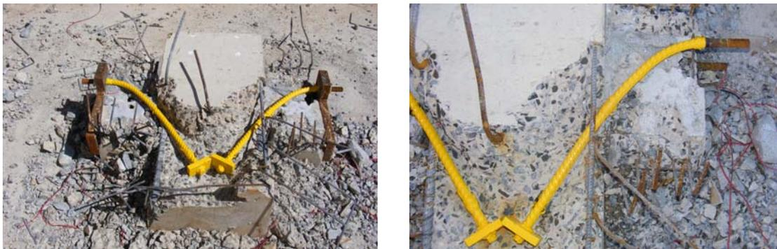
Figura 4.35: Deformada do chumbador do modelo 10.
