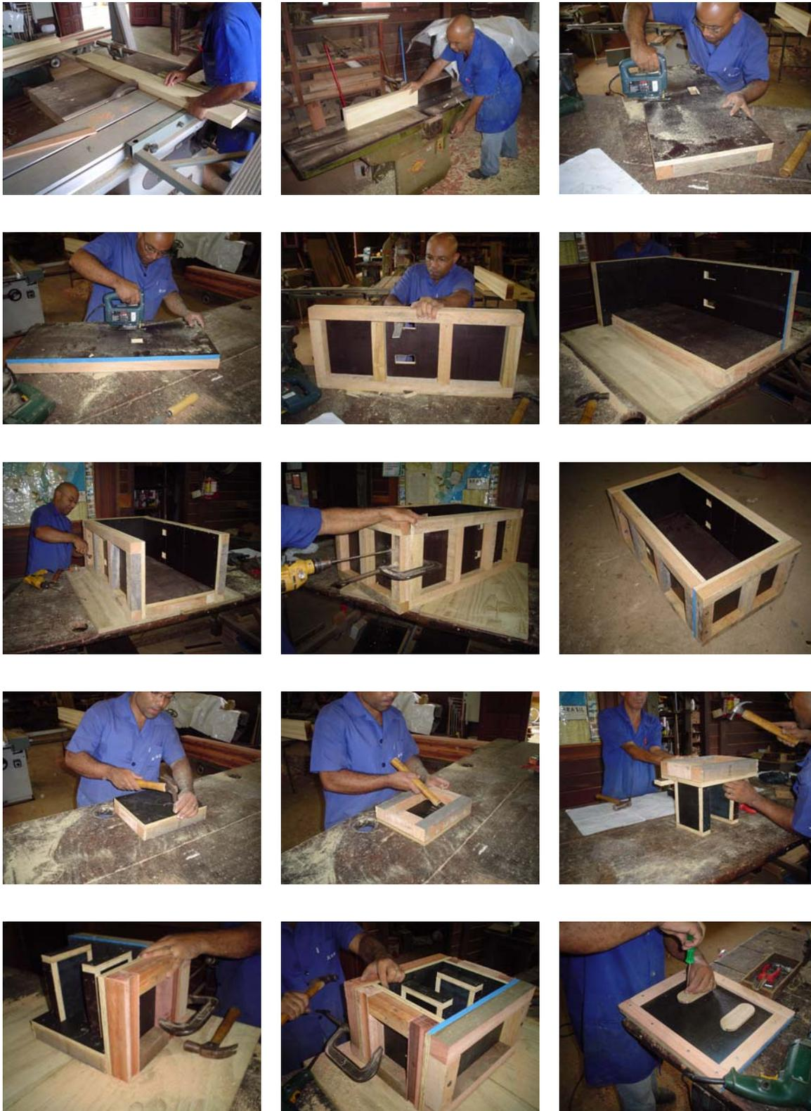
Figura 3.16: Seqüência de execução das formas de madeira
