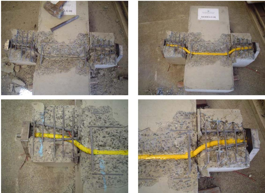
Figura 4.12: Deformada do chumbador do modelo 08
