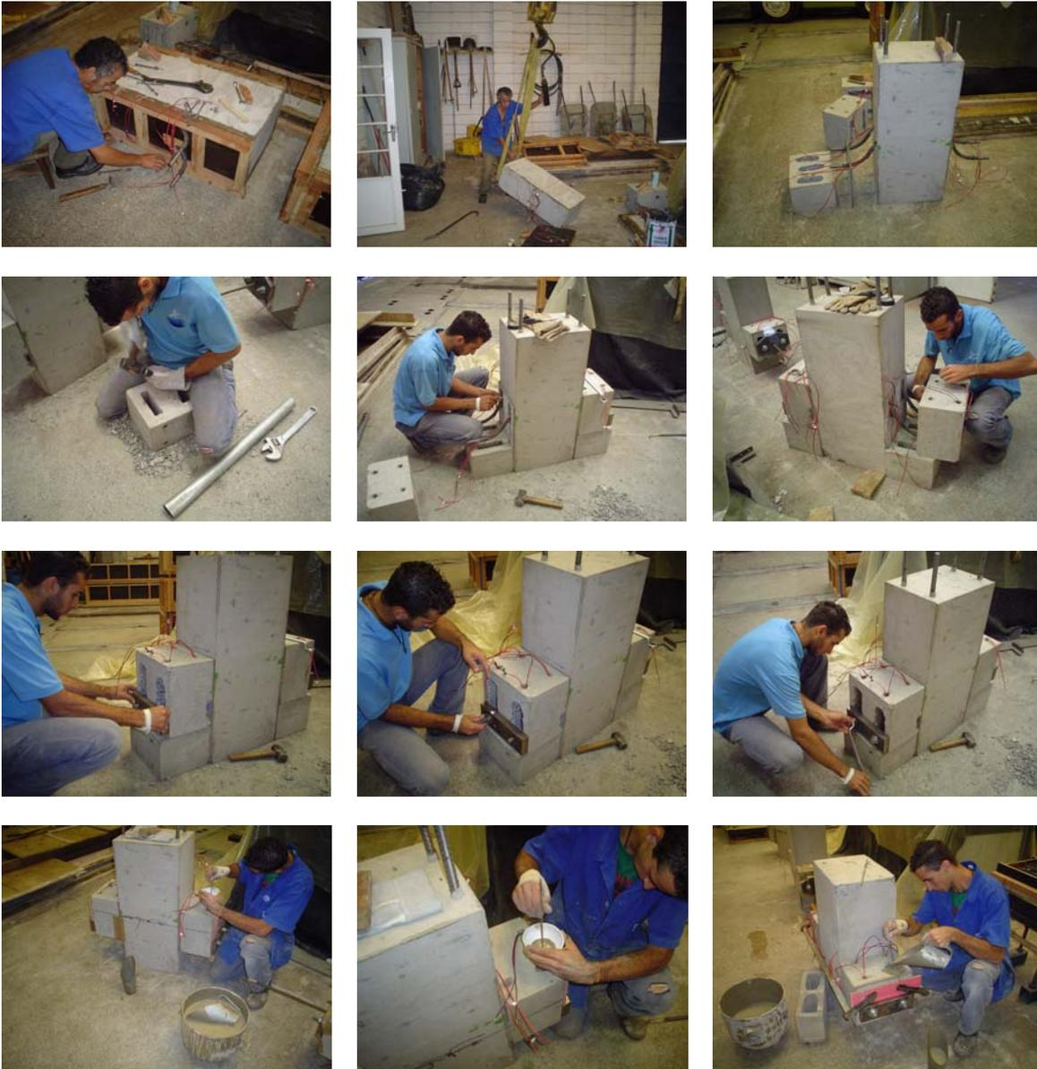
Figura 3.23: Seqüência de montagem dos modelos
