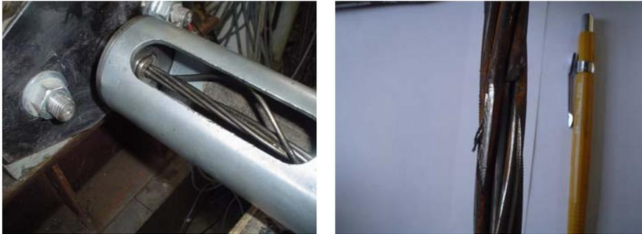
Figura 3.36: Aspecto do cabo de protensão de 15,2 mm
