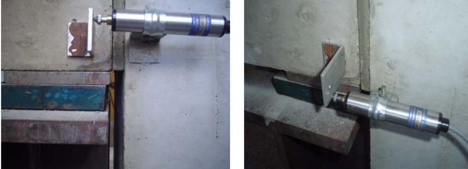
Figura 4.1: Detalhe do apoio utilizado nos modelos
