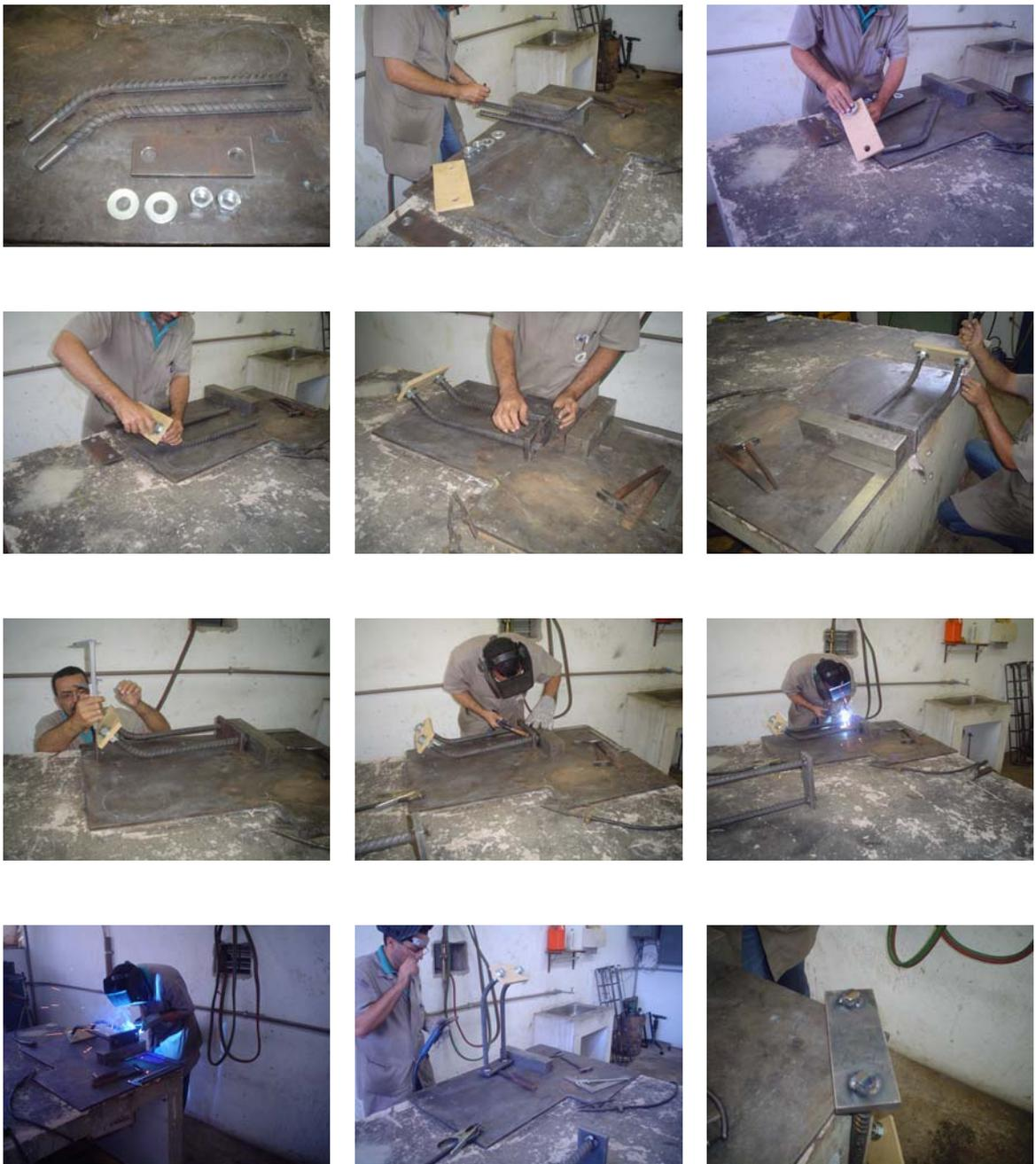
Figura 3.17: Confeção dos chumbadores usados nos modelos
