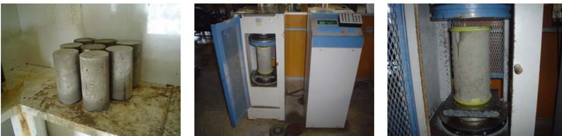
Figura 3.26: Cura e rompimento dos corpos-de-prova
