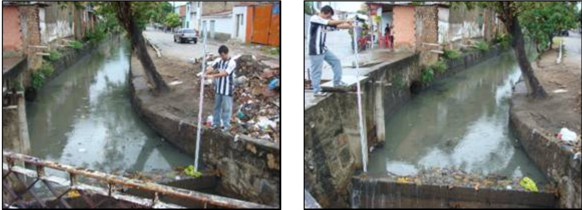
Figura 4.4. Fotografia da colocação da régua para estimativa dos níveis de água no riacho Gulandim
