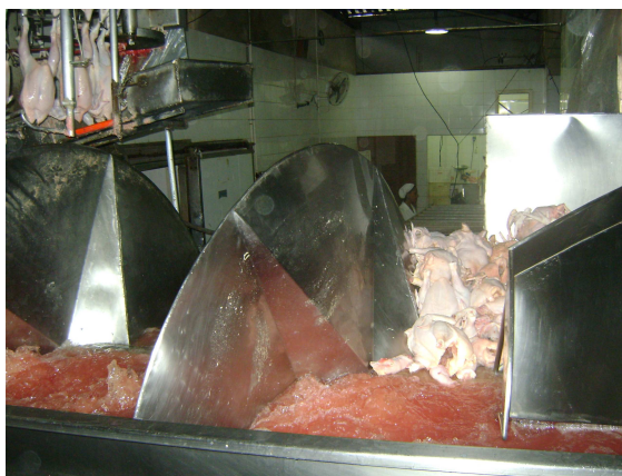
Figura 8. Chiller de pré-resfriamento.
