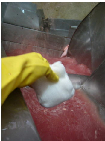
Figura 14. Mecha de gaze sendo colocada no pré-chiller .
