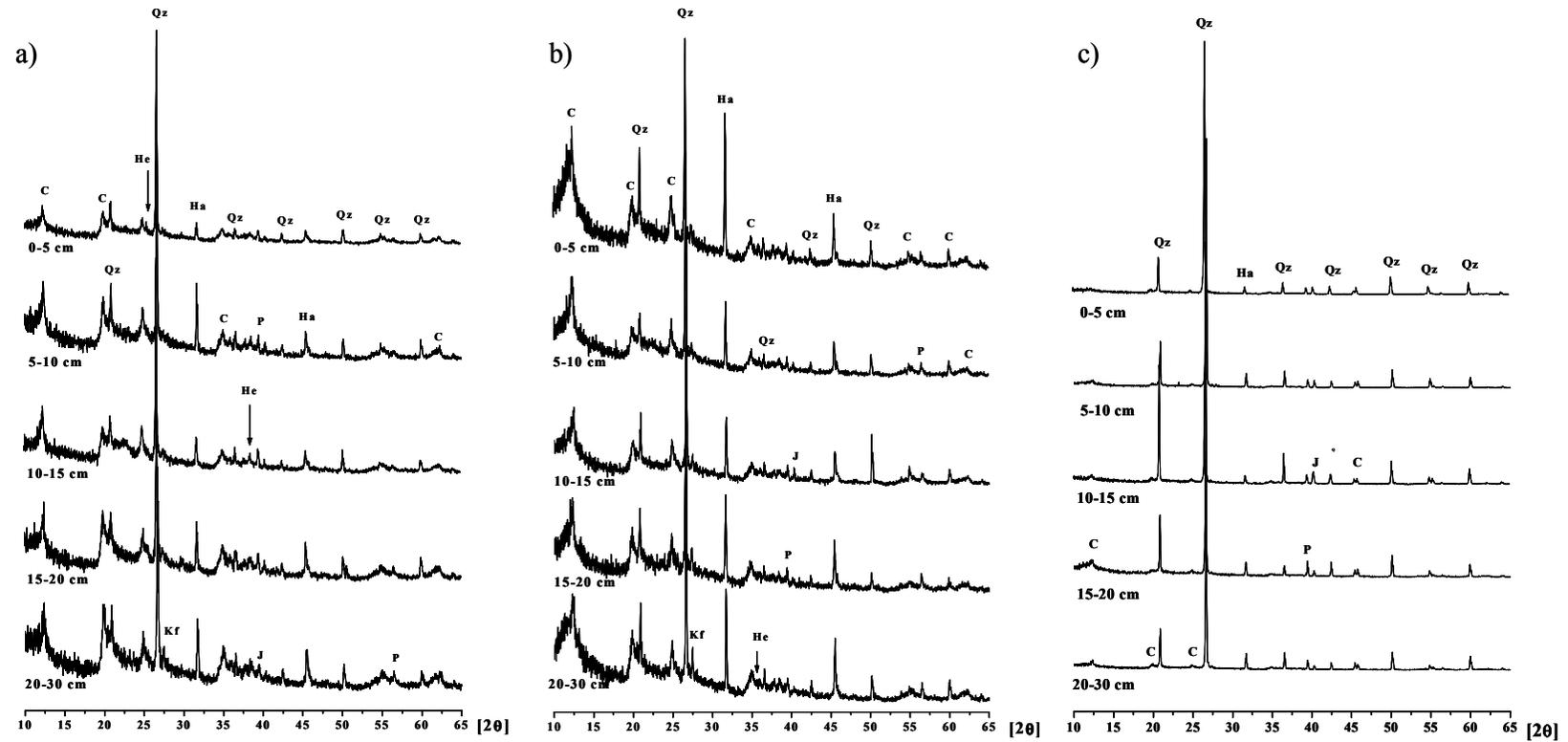
Figura 7 - Difratoograma de raios-x em amostras totais nos sedimento do manguezal de Bragança, T1 (a), T2 (b) e Platô herbáceo (c), mostrando seus principais minerais: C-caulinita, Qz-quartzo, He-hematita, Kf-K-feldspato, P-pirita, J-jarosita, e Ha-halita; PHb: C-caulinita, Qz-quartzo, P-pirita, J-jarosita, e Ha-halita.
