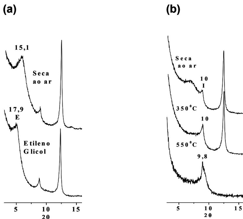
**Figura 13** – Difração de raios-X da fração argila dos sedimentos de mangue de Bragança após saturação com MgCl<sub>2</sub> (a) e com KCl (b).
