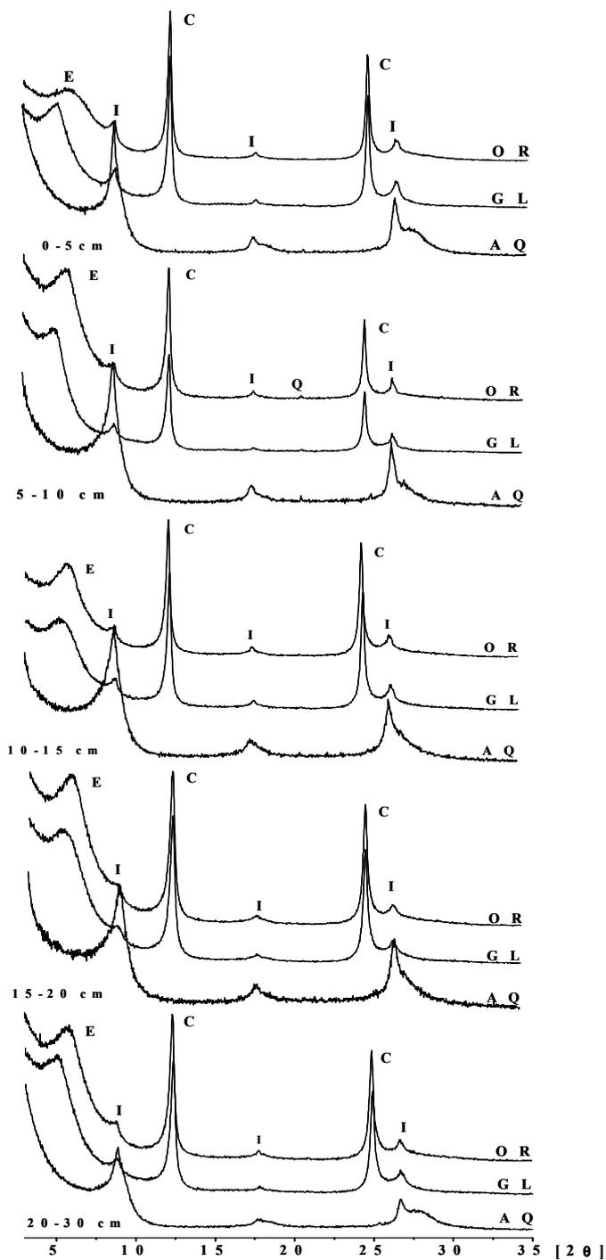
**Figura 12** - Difração de raios-X dos argilominerais presentes nos sedimentos do manguezal de Bragança (0-30 cm). Esmectita (E), Caulinita (C) e Ilita (I) em (T1), (T2) e (PHb). Lâminas orientadas (OR), solvatadas com etileno glicol (ELG) e aquecidas a 550° C (AQ).
