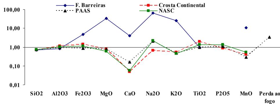
**Figura 14** - Normalização das concentrações dos elementos maiores em forma de óxidos (SiO<sub>2</sub>, Al<sub>2</sub>O<sub>3</sub>, Fe<sub>2</sub>O<sub>3</sub>, MgO, CaO, Na<sub>2</sub>O, K<sub>2</sub>O, TiO<sub>2</sub>, P<sub>2</sub>O<sub>5</sub> e MnO) nas transecções (T1 e T2) em relação à CTS Taylor & McLennan (1985); Padrões PASS Taylor & McLennan (1985); NASC Gromet et al.. (1984) e Formação Barreiras Berrêdo (2006).
