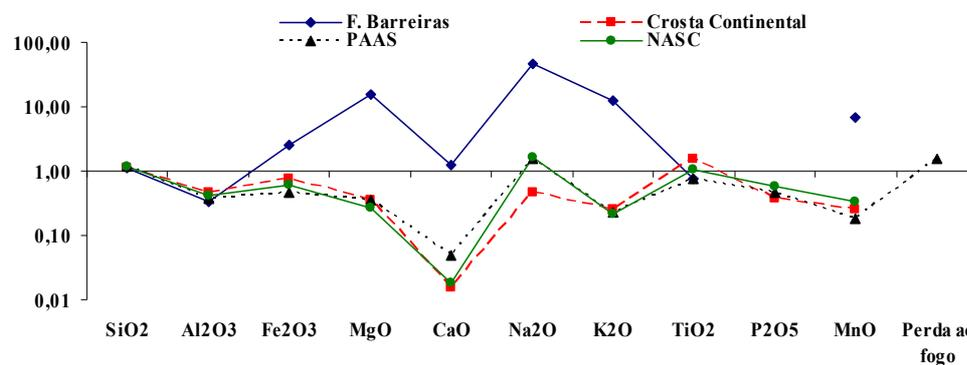
**Figura 15** - Normalização das concentrações dos elementos maiores em forma de óxidos (SiO<sub>2</sub>, Al<sub>2</sub>O<sub>3</sub>, Fe<sub>2</sub>O<sub>3</sub>, MgO, CaO, Na<sub>2</sub>O, K<sub>2</sub>O, TiO<sub>2</sub>, P<sub>2</sub>O<sub>5</sub> e MnO) em PHb em relação à CTS (Taylor & McLennan 1985); Padrões PASS (Taylor & McLennan 1985); NASC (Gromet et al.. 1984) e Formação Barreiras (Berrêdo 2006).
