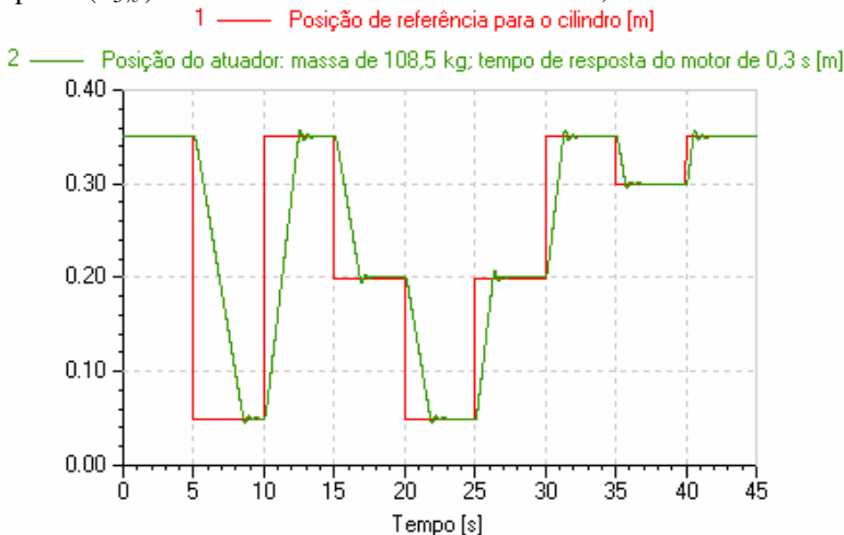
Figura 7.35 – Posicionamento de um cilindro hidráulico com o emprego de duas VRI.
