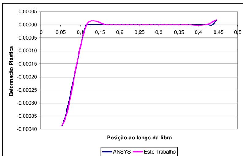
Figura 7.56 Comparativo das deformações plásticas no estribo central.
