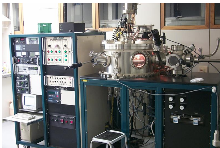
FIG. 2.15 - Sistema de deposição por pulverização catódica por RF ou DC do CBPF.
