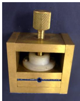
FIG. 4.13 - Sistema de pressão confeccionado em latão.
