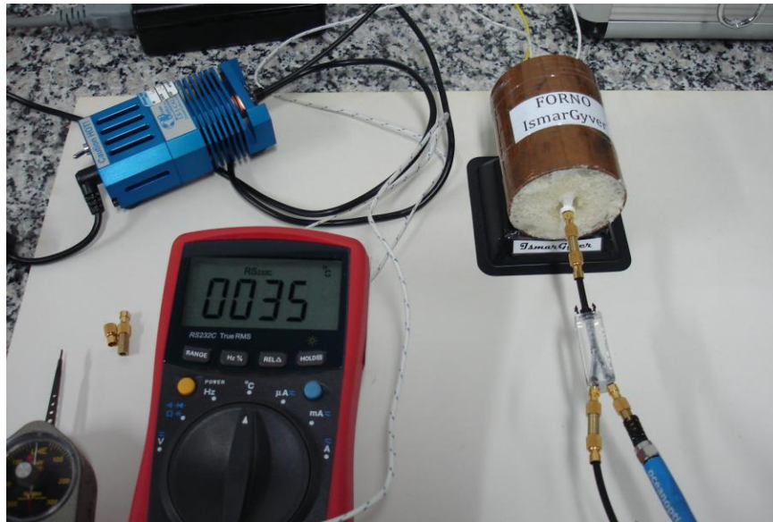
FIG. 5.72 Medindo a variação de temperatura com o sensor de Bragg.
