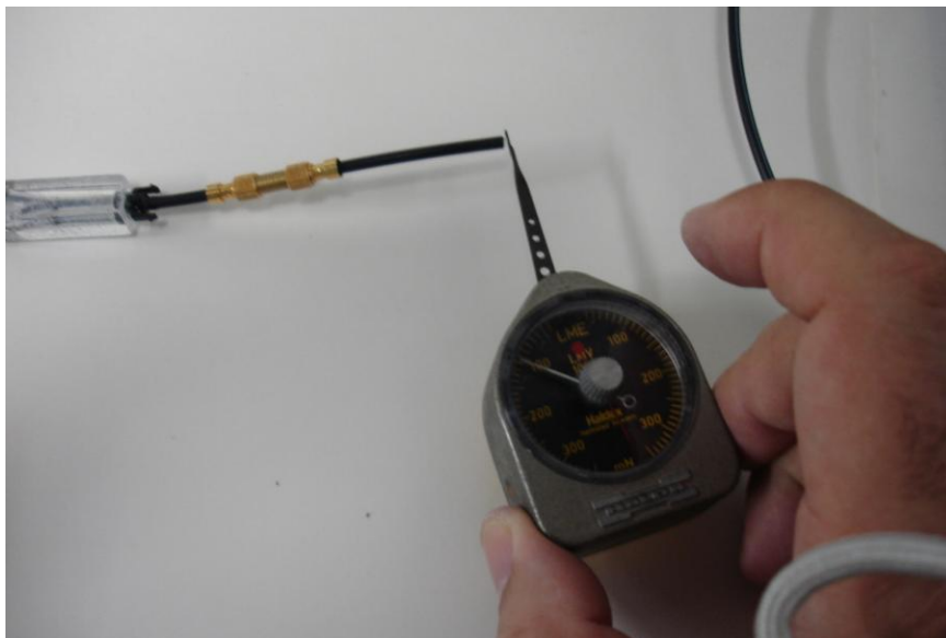
FIG. 5.71 - Aplicando uma força no sensor RBF.
