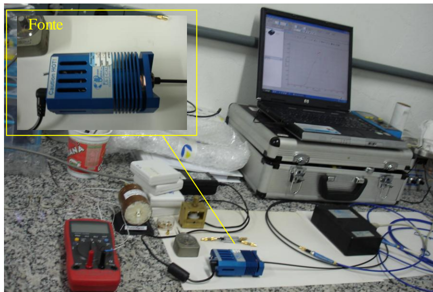
FIG. 5.73 – Sistema de medição, mostrando a curva de transmitância da fibra. Nesta foto está todos os componentes usados na caracterização do sensor, em destaque a fonte luminosa com a fibra acoplada.
