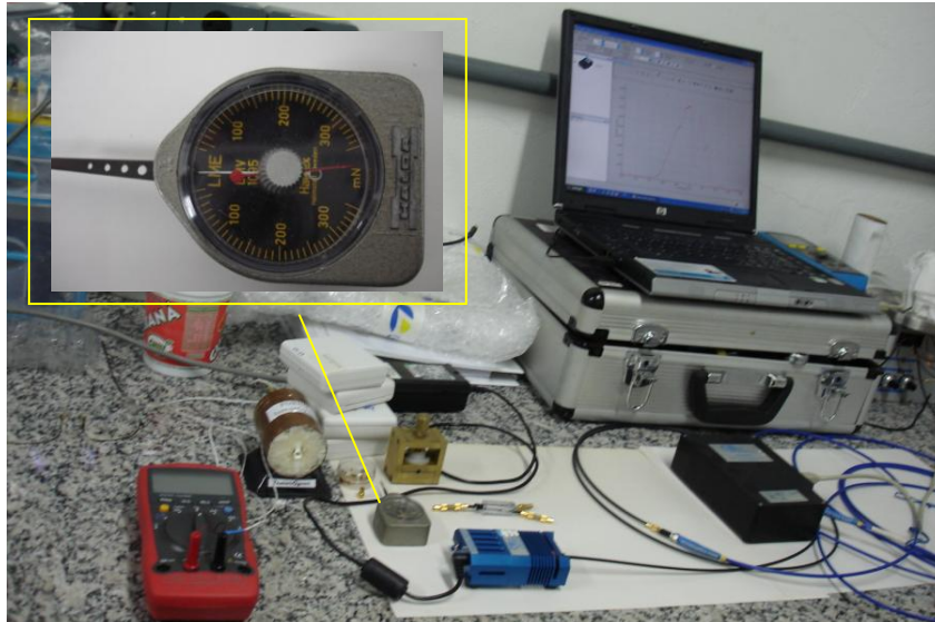
FIG. 4.14 – Dinamômetro em miline wton empregado para pressionar a ponta da RBF e a montagem de medidas.
