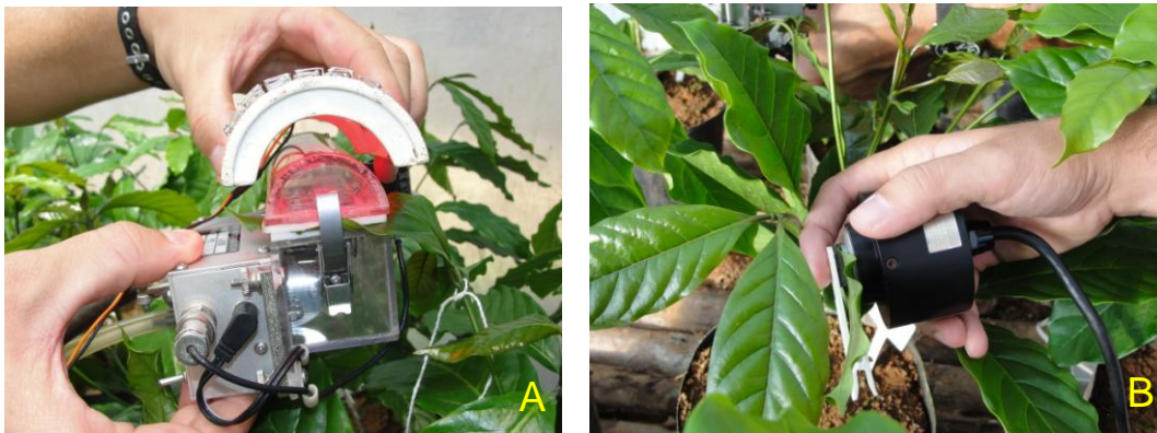
Figura 7. Medição das Trocas Gasosas (A), com o Sistema Portátil Modelo LI-6200 e Fluorescência da clorofila a (B), com um Fluorímetro não-modulado PEA, em plantas de café Conilon variedade Vitória, Clone 02, no interior da estufa, em Marechal Floriano, ES.
