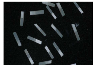
Fig. 2d: Corpos de prova obtidos para ensaios de microtração.
