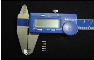
Fig. 3a: Paquímetro digital (Miutoyo). Utilizado para mensuração das dimensões necessárias para cálculo da área de união ( \text{mm}^2 ).
