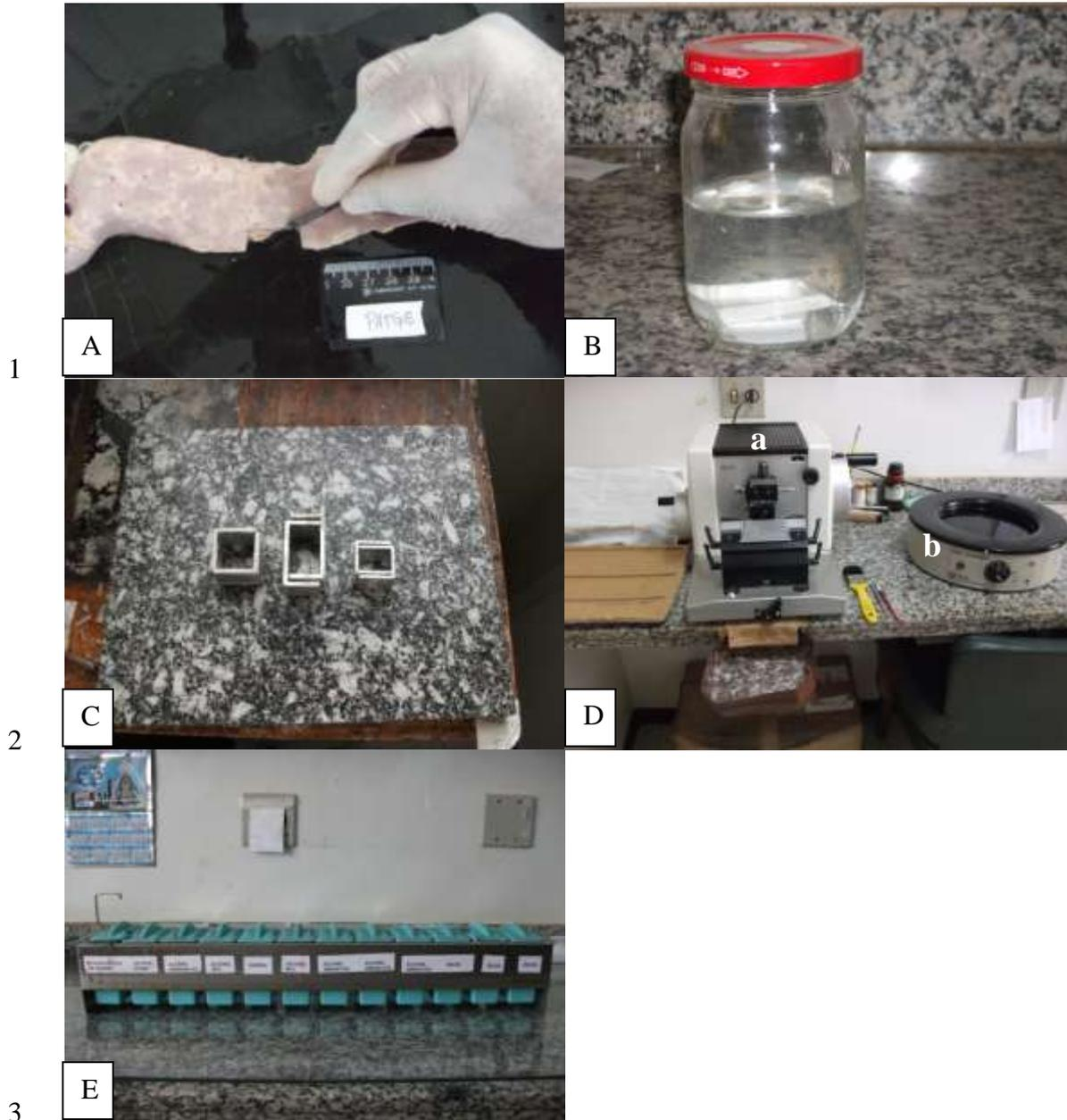
**Figura 2.** A- Corte do fragmento da aorta para processamento histológico. B-Fixação do fragmento em formaldeído 3,7%. C- Inclusão do fragmento em parafina. D- Micrótomo (a) e banho Maria (b) para preparo das lâminas. E – Bateria de coloração.
