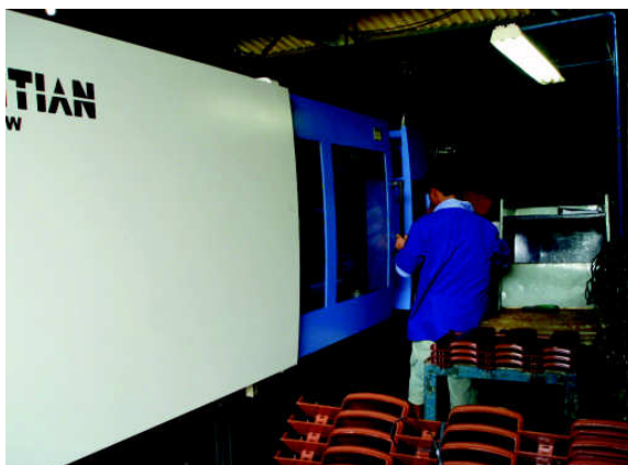
Figura 38 - Retirada da telha do molde.
