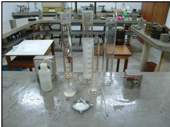
**Figura 5.** Pó de cimento endodôntico (bandeja metálica) e solução defloculante.
