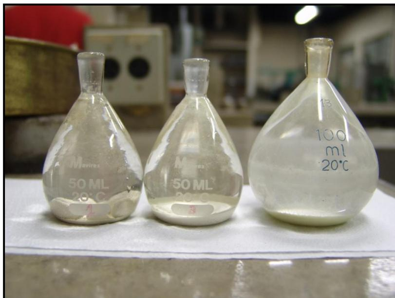
**Figura 9.** Picnômetros contendo pó dos cimentos Pulp Canal Sealer EWT<sup>®</sup> (E), Intrafill<sup>®</sup> (C) e Sealer 26<sup>®</sup> (D).
