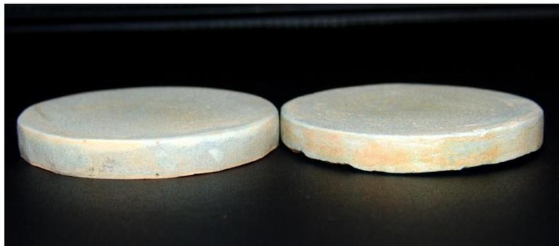
**Figura 13.** Amostras de Sealer 26® extraídas dos anéis metálicos.
