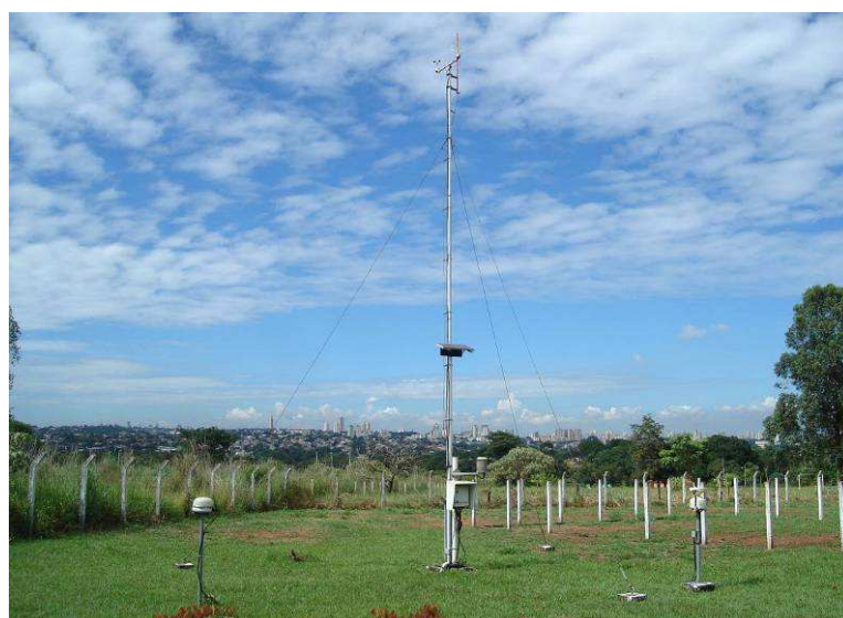
Figura 4.2 - Estação automática do 10º DISME (Décimo Distrito Meteorológico) do Instituto Nacional de Meteorologia – INMET
