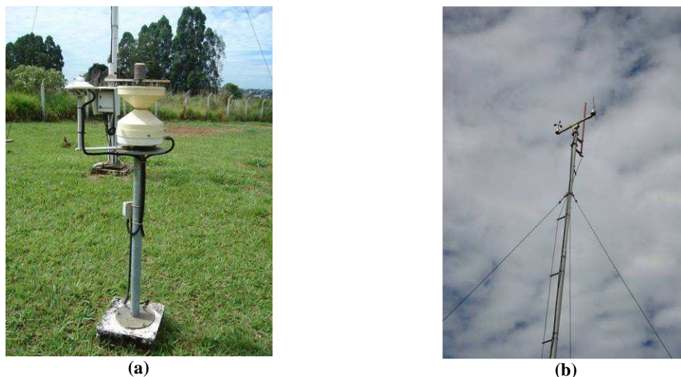
Figura 4.3 - Udógrafo (a) e cata-vento e anemômetro (b) da estação automática do 10º DISME (Décimo Distrito Meteorológico) do Instituto Nacional de Meteorologia – INMET
